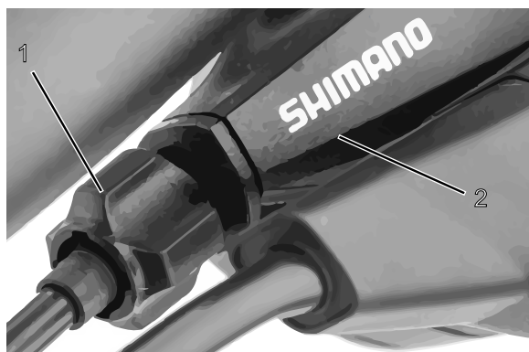
Figura 54: Casquillo de ajuste (1) del cambio de marchas accionado por cable de accionamiento con carcasa de la palanca de cambio (2), ejemplo
