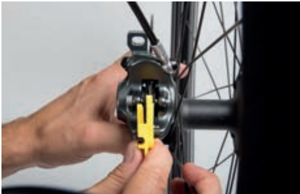
Abbildung 139: Bremsbelag im eingebauten Zustand mithilfe der Transportsicherung prüfen
