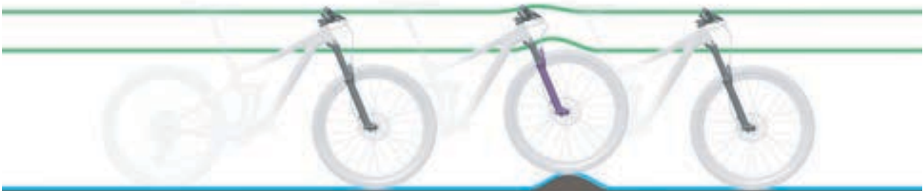
Abbildung 10: Optimales Fahrverhalten der Gabel bei Unebenheiten
