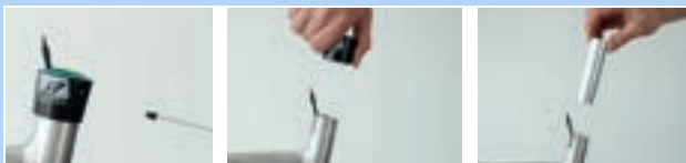
Abbildung 157: Außenhülle und Gleitbuchse ausbauen
