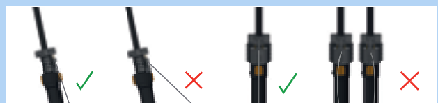
Abbildung 176: Korrekter und falscher Bowdenzug
