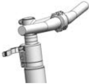
Abbildung 130: All Up mit geöffnetem Vorbau-Spannhebel
