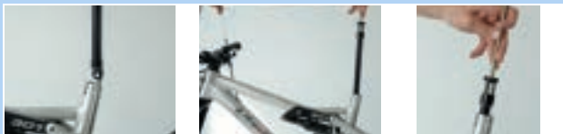
Abbildung 177: Kartusche Ventildeckel befestigen
