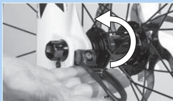
Abbildung 69: Schnellspannhebel in Pfeilrichtung drücken
