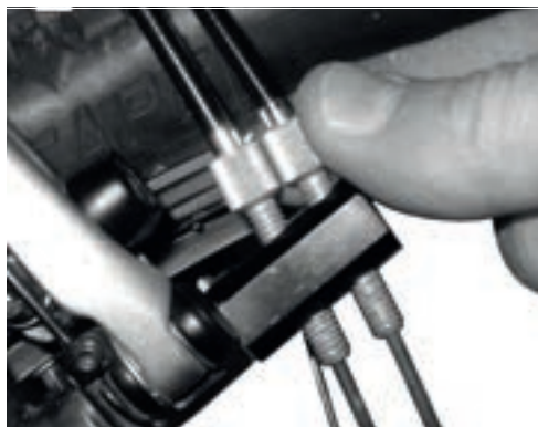
Abbildung 142: ROHLOFF-Naben Versionen mit interner Schaltansteuerung haben die Zugeinsteller am Zuggegenhalter
