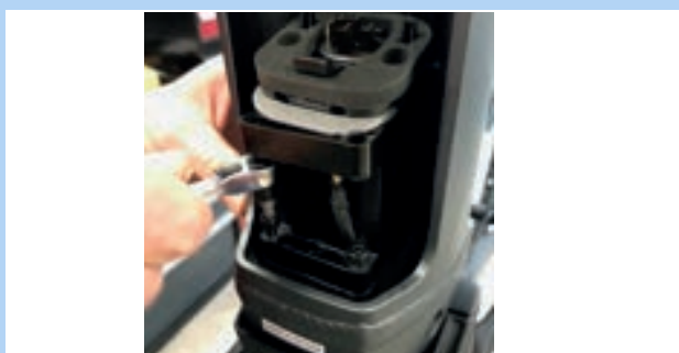
Abbildung 48: 4 mm 6-Kant-Schrauben entfernen
