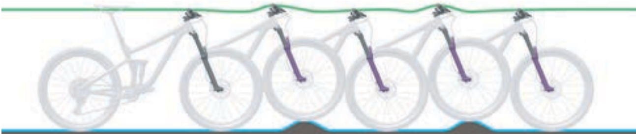
Abbildung 105: Optimales Fahrverhalten der Gabel
