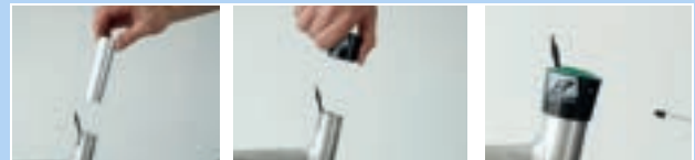
Abbildung 173: Gleitbuchse und Außenhülse einbauen
