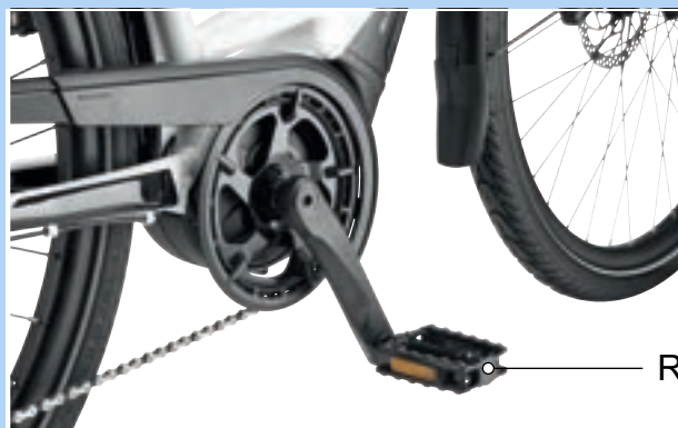
Abbildung 78: R-Pedal im rechten Kurbelarm
