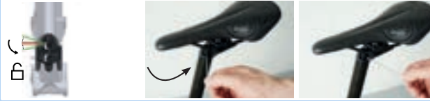
Abbildung 149: Höhenverstellungsbetätigung in „Geöffnete Stellung“ bringen
