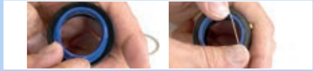
Abbildung 198: Abstreifer einlegen und befestigen
