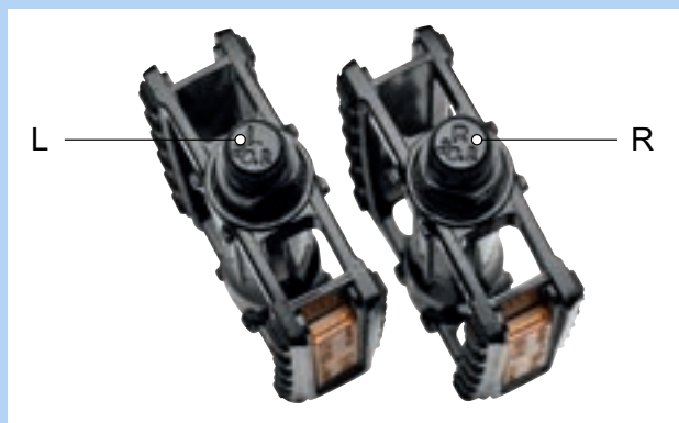
Abbildung 76: Beispiel Kennzeichnung von Pedalen
