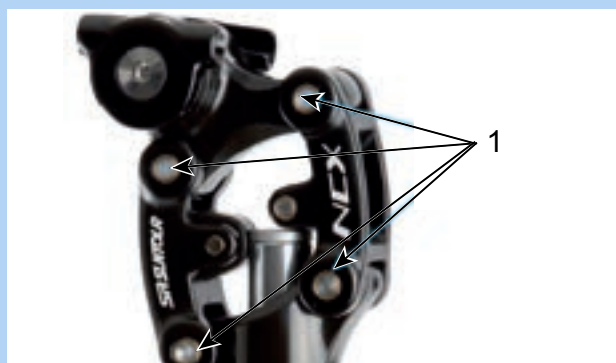
Abbildung 148: Schmierpunkte SR Suntour Feder-Sattelstütze
