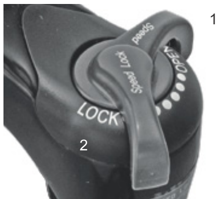
Rysunek 63: Nastawnik dobicia Suntour z pozycjami OPEN (1) i LOCK (2)
