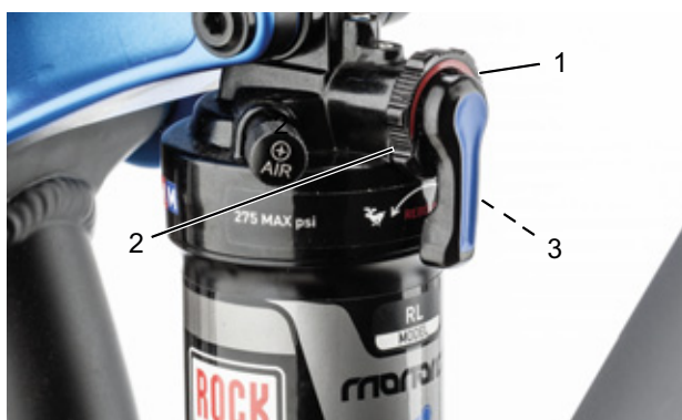
Illustration 82 : Régler la dureté de l'amortisseur de détente (1) de l'amortisseur arrière
