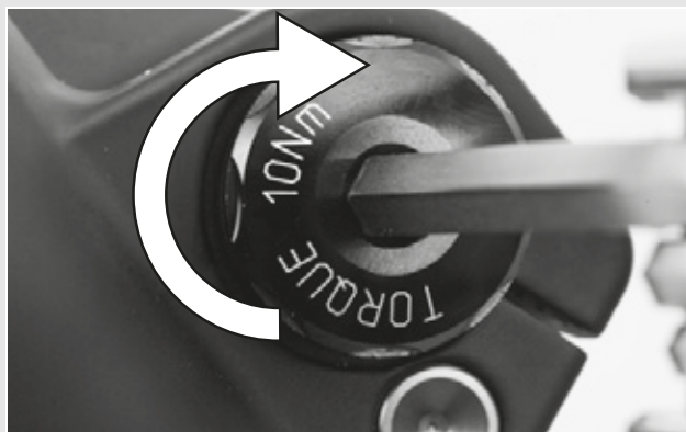
Illustration 29 : Serrer l'axe inséré
