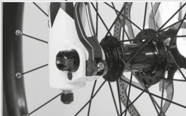
Illustration 35 : Position parfaite du levier de serrage
