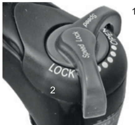
Abbildung 65: Suntour-Druckstufeneinsteller mit den Positionen OPEN (1) und LOCK (2)
