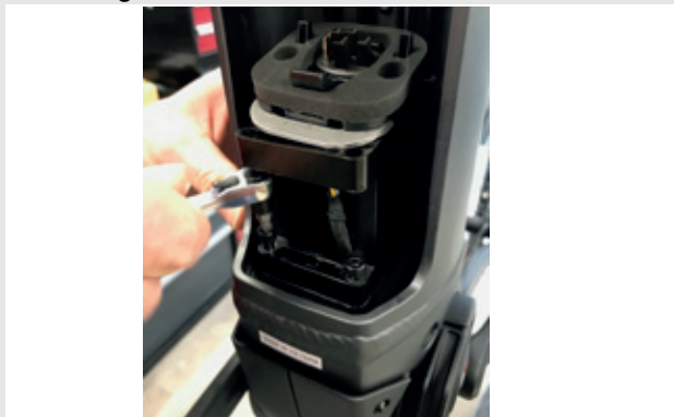
Figura 23: Rimozione delle viti a testa esagonale da 4 mm
