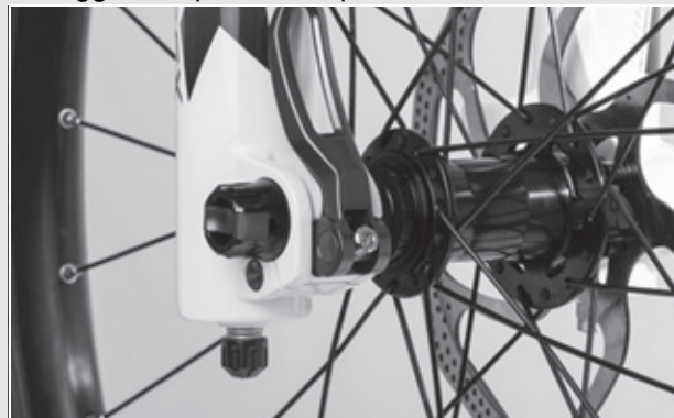
Figura 38: Corretta posizione della leva di serraggio
