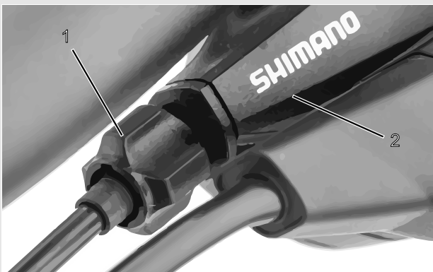
Figura 69: Boccola di regolazione (1) del cambio azionato da cavo singolo con scatola della leva del cambio (2), esempio
