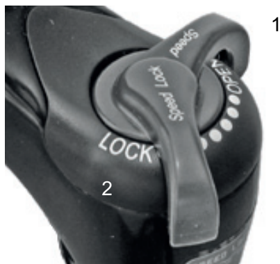
Figura 64: Regolatore dello stadio di pressione Suntour con posizioni OPEN (1) e LOCK (2)
