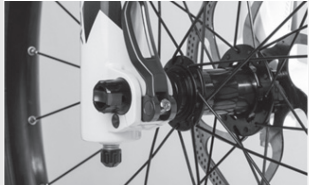
Figura 67: Regolazione della forza di serraggio del bloccaggio rapido
