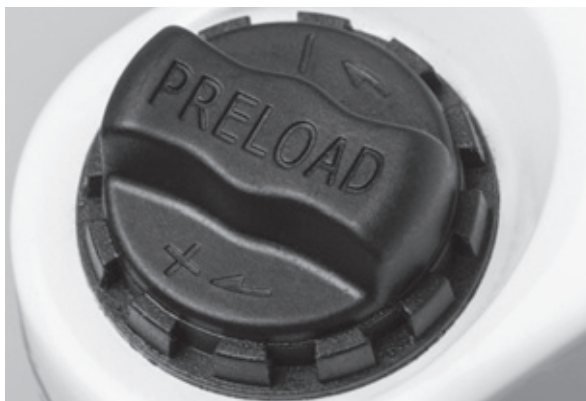
Figura 55: Manopola di regolazione dell'escursione negativa della sospensione sulla corona della forcella ammortizzata
