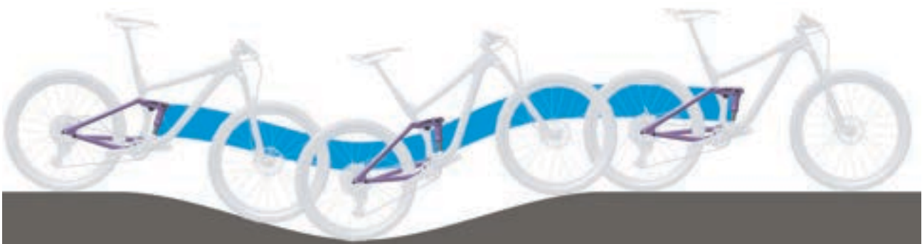
Abbildung 16: Optimales Fahrverhalten des Hinterbau-Dämpfers im hügeligen Gelände
