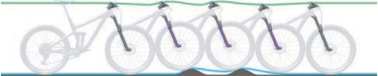
Abbildung 231: Zu langsames Ausfedern der Federgabel
