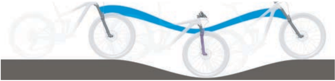
Abbildung 233: Zu weiche Federung der Federgabel am Berg
