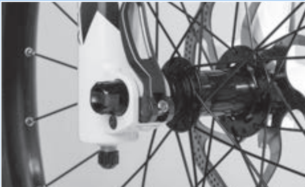
Abbildung 156: Spannkraft des Schnellspanners einstellen
