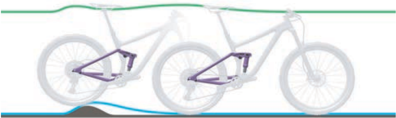
Abbildung 245: Zu harte Dämpfung des Hinterbau-Dämpfers bei Unebenheiten
