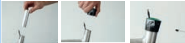
Abbildung 216: Gleitbuchse und Außenhülse einbauen
