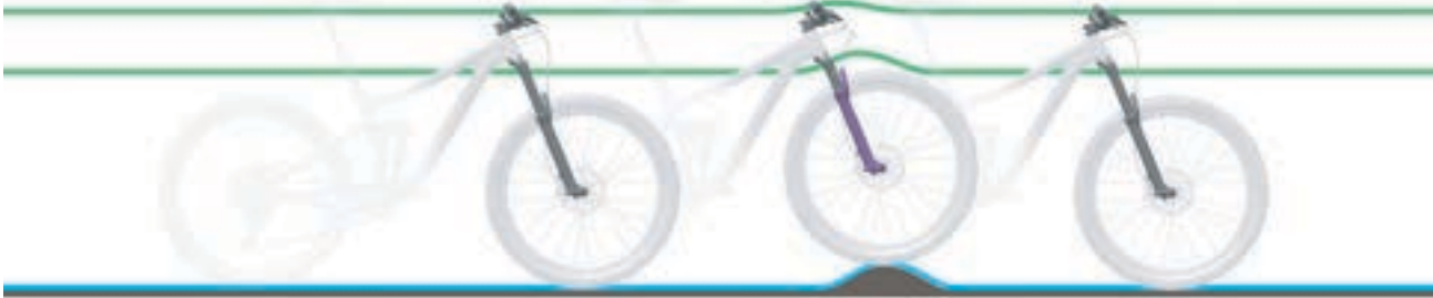
Abbildung 134: Optimales Fahrverhalten bei Unebenheiten
