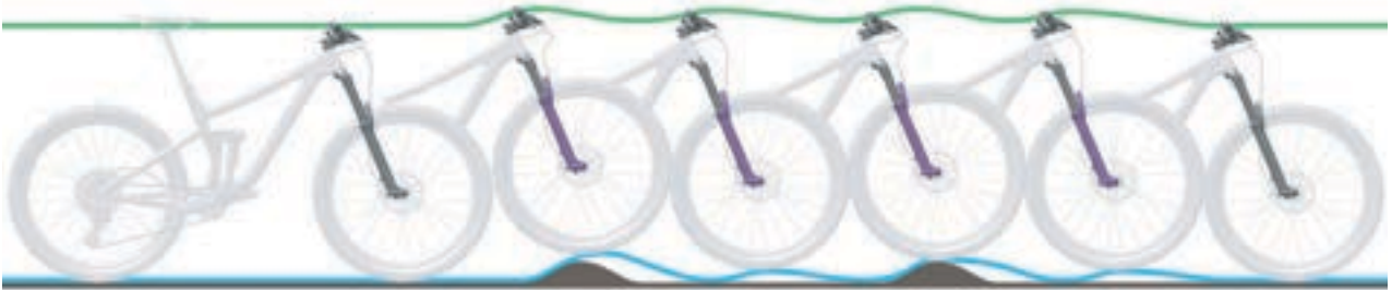
Abbildung 221: Zu schnelles Ausfedern der Federgabel
