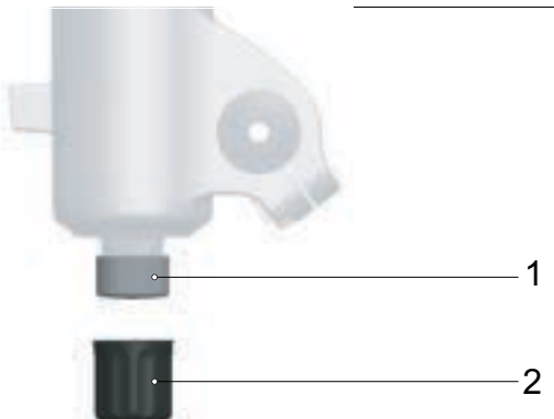
Abbildung 232: FOX Zugstufen-Schraube (1) unter Gabel-Kappe (2)
