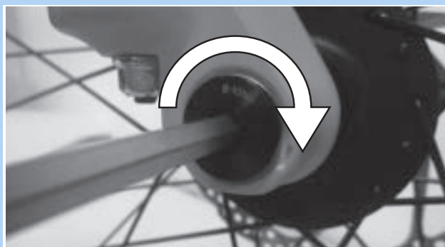
Abbildung 62: Achse in Pfeilrichtung anziehen
