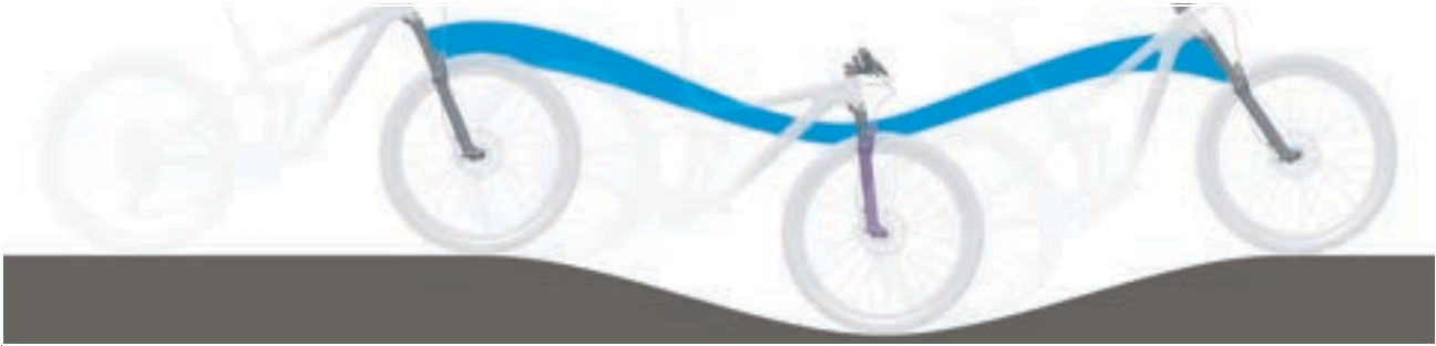
Abbildung 225: Zu weiche Federung der Federgabel am Berg
