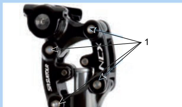
Abbildung 158: Schmierpunkte SR Suntour Feder-Sattelstütze
