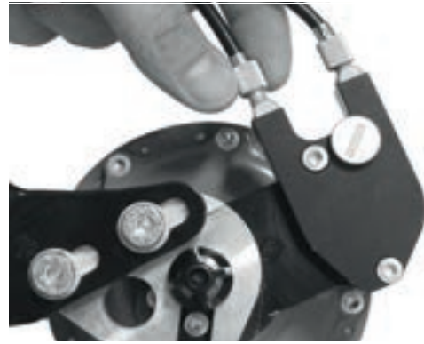
Abbildung 153: ROHLOFF-Naben Versionen mit externer Schaltansteuerung haben die Zugeinsteller an der Seilbox, die sich auf der linken Seite befindet
