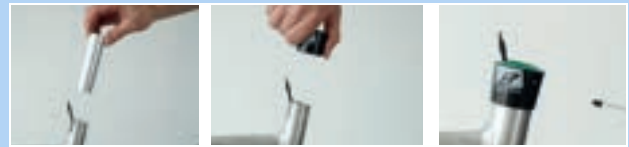
Abbildung 183: Gleitbuchse und Außenhülse einbauen
