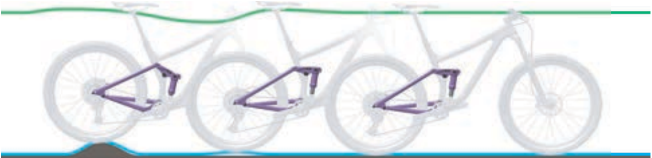
Abbildung 239: Zu schnelles Ausfedern des Hinterbau-Dämpfers
