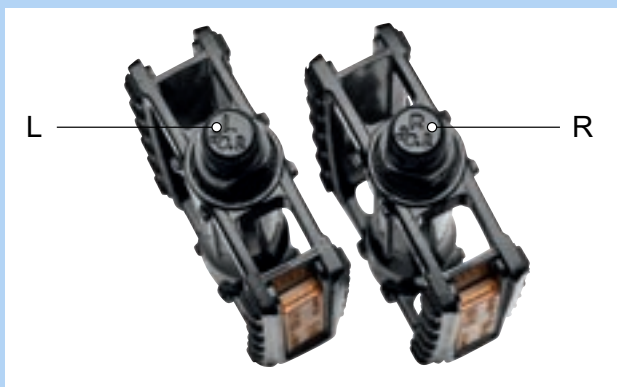
Abbildung 80: Beispiel Kennzeichnung von Pedalen
