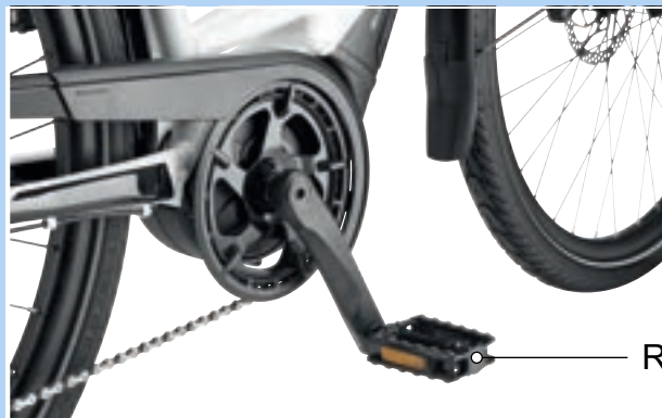
Abbildung 82: R-Pedal im rechten Kurbelarm
