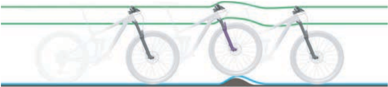
Abbildung 227: Zu harte Dämpfung der Federgabel bei Unebenheiten
