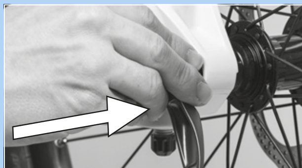
Obr. 92: Zasunutí rychloupínáku ve směru šipky
