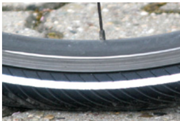
Obr. 124: Správný tlak. Pláště se působením hmotnosti těla téměř nezdeformuje
