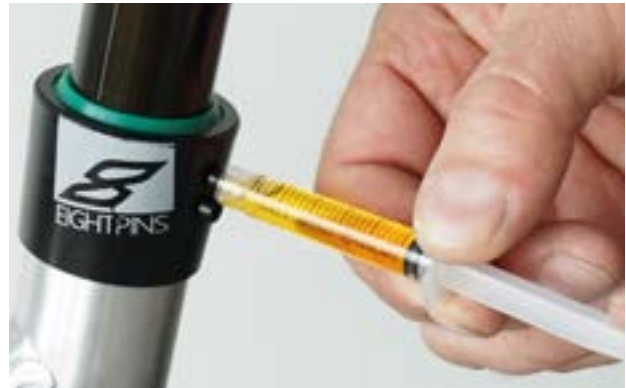
Obr. 183: Namazání sedlovky eightpins
