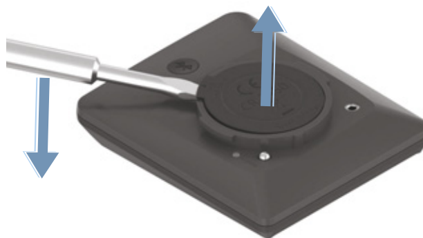
Obr. 147: Zvednutí víka přihrádky na baterii
