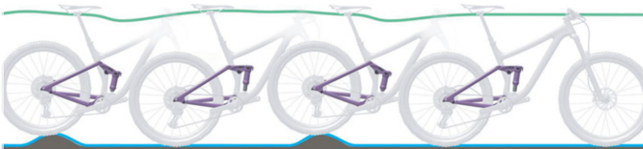
Obr. 5: Optimální chování tlumiče zadního odpružení při jízdě
