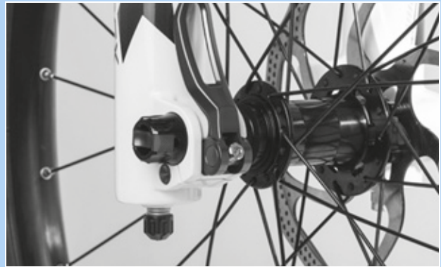
Obr. 215: Nastavení upínací síly rychloupínáku
