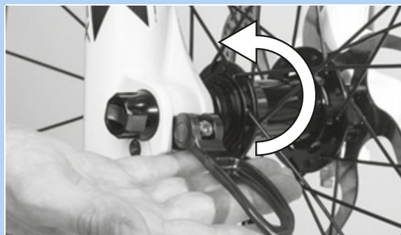
Obr. 88: Stlačte páku rychloupínáku ve směru šipky
