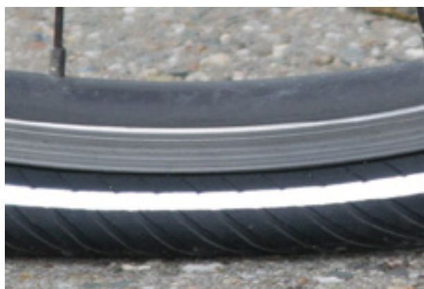
Obr. 125: Příliš nízký tlak
