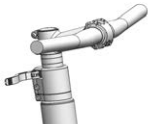
Obr. 178: Příklad All Up s otevřenou upínací pákou představce
