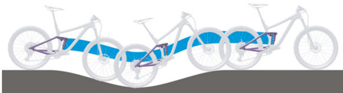
Obr. 137: Optimální chování tlumiče zadního odpružení při jízdě v kopcovitém terénu
