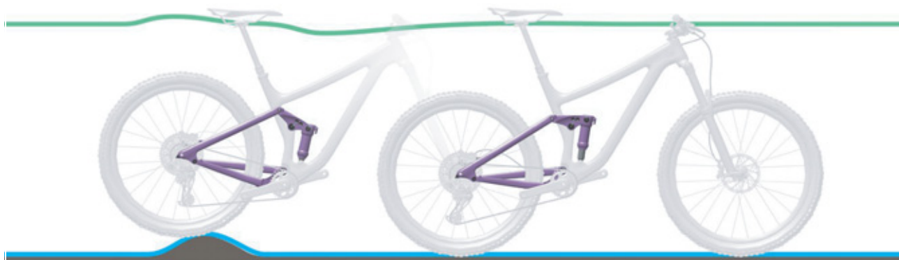
Obr. 165: Optimální chování tlumiče zadního odpružení při jízdě u nerovností
