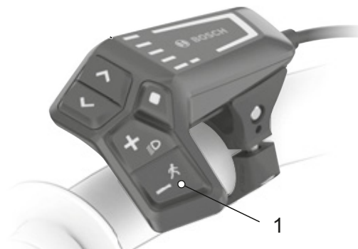
Obr. 173: Umístění tlačítka funkce podpory tlačení (1)
