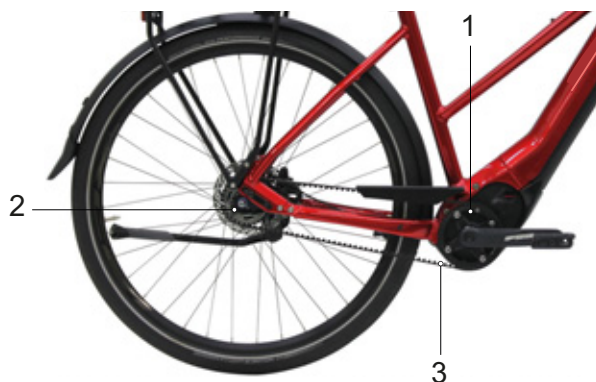
Obr. 47: Schéma řemenového pohonu
