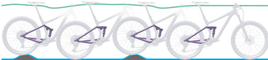
Obr. 136: Optimální chování tlumiče zadního odpružení při jízdě
