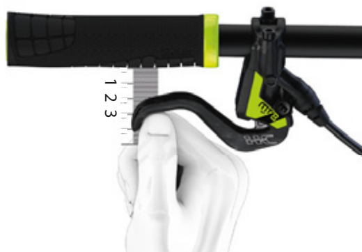
Obr. 129: Polohování ruční brzdy
