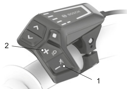
Obr. 174: Umístění tlačítek Plus a Minus
