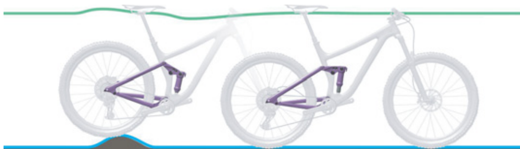
Obr. 138: Optimální chování tlumiče zadního odpružení při jízdě u nerovnosti
