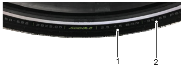
Obr. 184: Údaj tlaku v barech (1) a psi (2)
