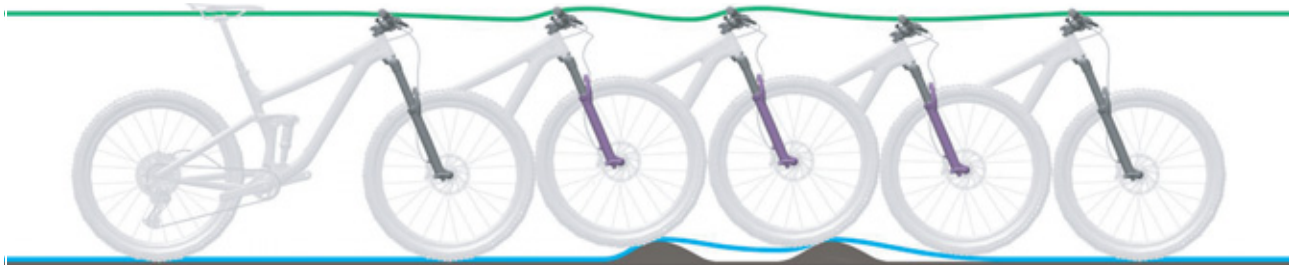
Obr. 221: Příliš pomalé roztahování odpružené vidlice
