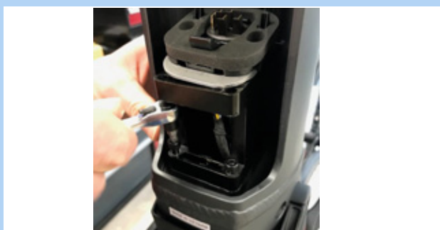
Obr. 68: Odstranění 6hranných šroubů 4 mm
