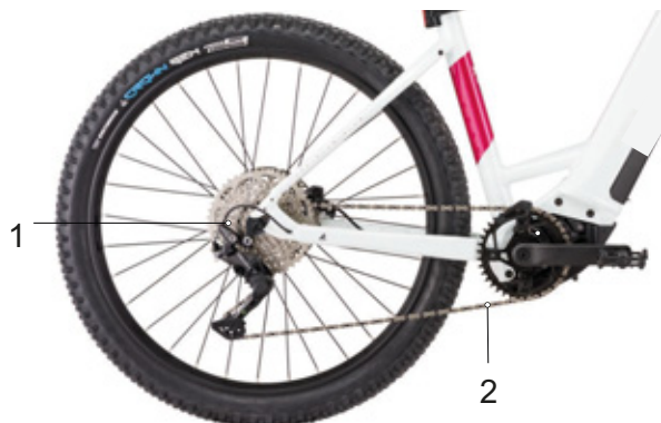
Obr. 46: Schéma řetězového převodu s přesmykačem
