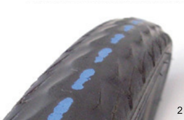
Obr. 185: Plášť bez profilu, který může být vyměněn (1) a plášť s proraženou ochranou (2), který je třeba vyměnit
