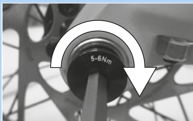
Obr. 84: Utažení pojistného šroubu
