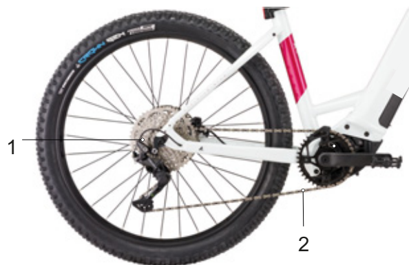
Rysunek 26: Schemat napędu łańcuchowego z przerzutką
