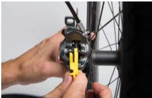
Rysunek 146: Sprawdzenie stanu klocków hamulca w stanie zamontowanym za pomocą zabezpieczenia transportowego
