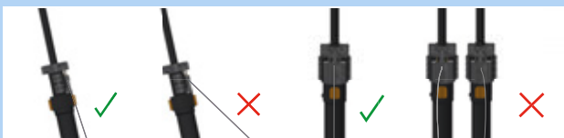
Rysunek 184: Prawidłowa i nieprawidłowa pozycja cięgna Bowdena
