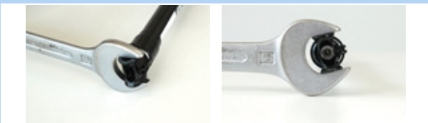
Rysunek 178: Zabezpieczenie przed przekręceniem się
