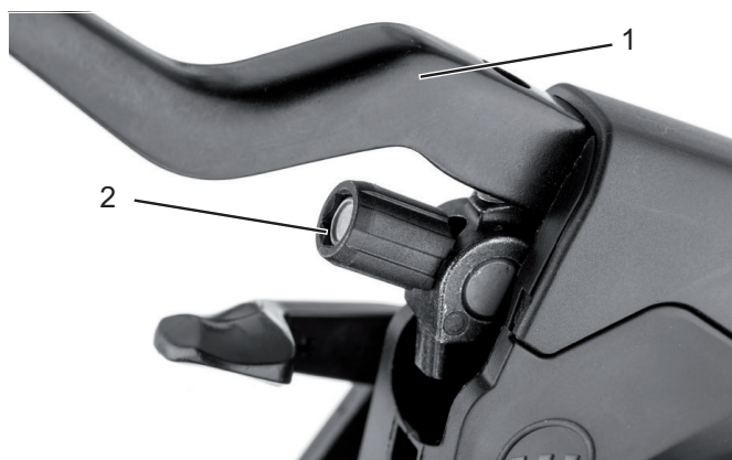
Illustration 77 : Levier de frein (1) du frein de jante à actionnement hydraulique avec vis de réglage (2)
