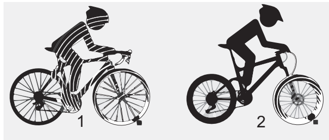
Illustration 5 : Vélo sans suspension (1) et avec suspension (2) lors du franchissement d'un obstacle
