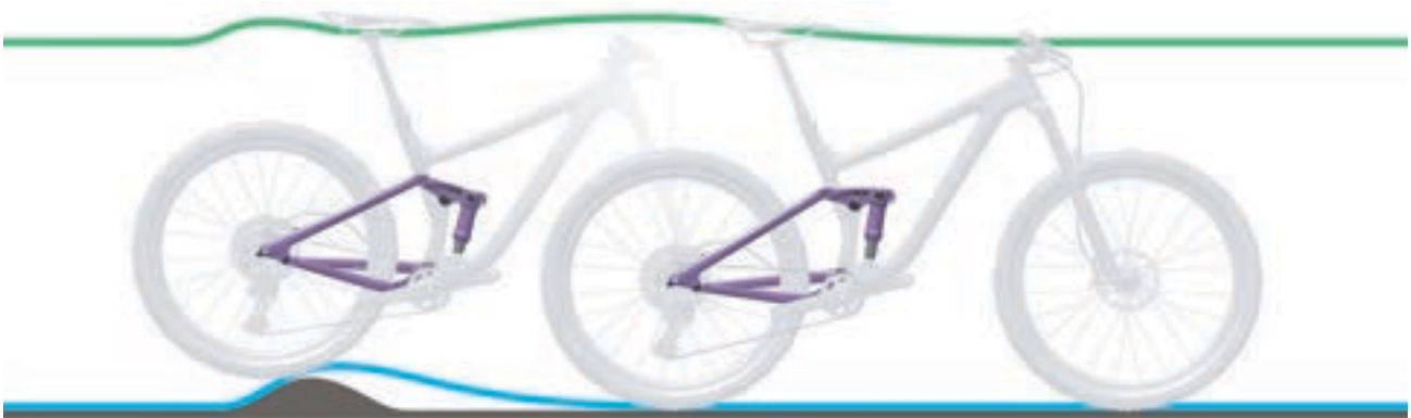
Abbildung 225: Zu harte Dämpfung des Hinterbau-Dämpfers bei Unebenheiten
