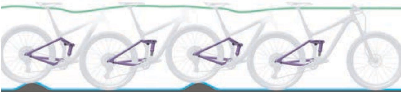
Abbildung 101: Optimales Fahrverhalten des Hinterbau-Dämpfers
