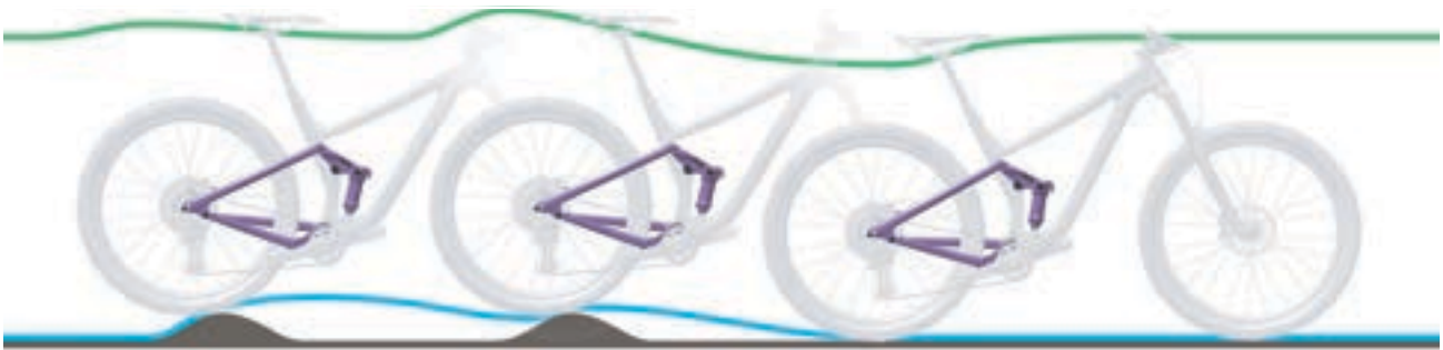
Abbildung 221: Zu langsames Ausfedern des Hinterbau-Dämpfers
