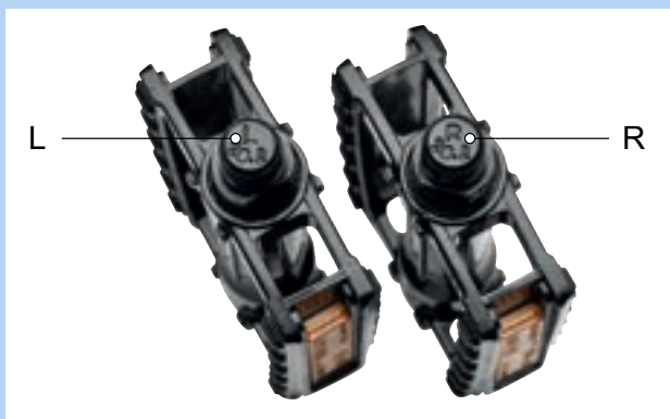
Abbildung 67: Beispiel Kennzeichnung von Pedalen
