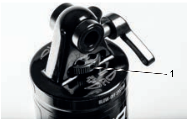
Abbildung 220: Suntour-Zugstufeneinsteller Rad (1) am Hinterbau-Dämpfer
