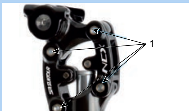
Abbildung 148: Schmierpunkte SR Suntour Feder-Sattelstütze
