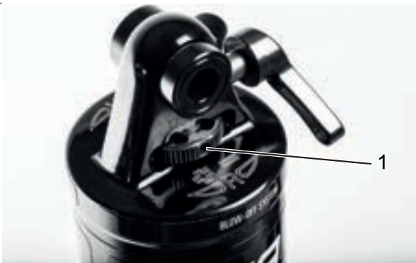
Abbildung 222: Suntour-Zugstufeneinsteller Rad (1) am Hinterbau-Dämpfer
