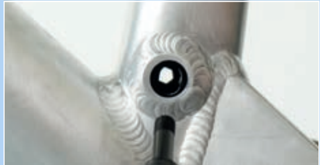
Abbildung 209: Loch der Postpin Schnittstelle
