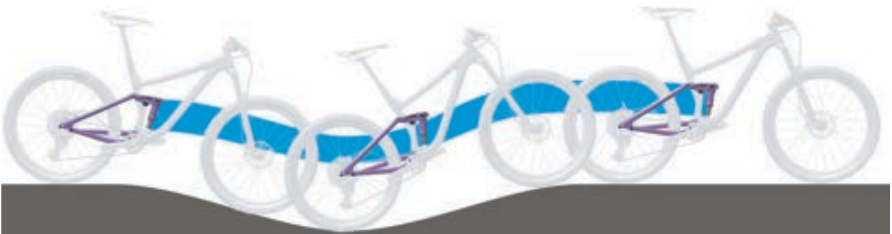
Abbildung 21: Optimales Fahrverhalten des Hinterbau-Dämpfers im hügeligen Gelände
