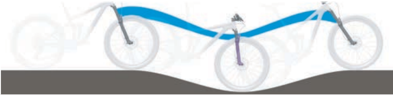
Abbildung 215: Zu weiche Federung der Federgabel am Berg
