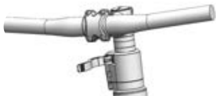
Abbildung 114: Beispiel All Up mit geöffnetem Vorbau-Spannhebel
