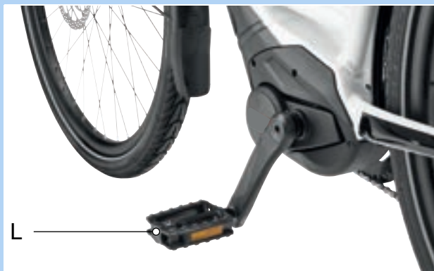
Abbildung 68: L-Pedal im linken Kurbelarm
