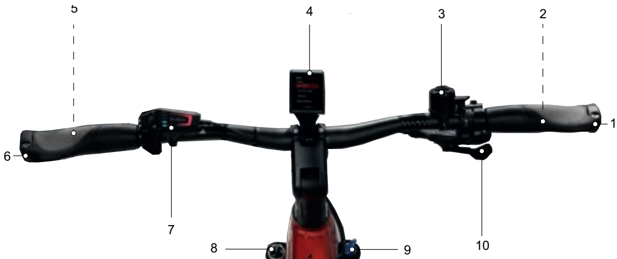
Abbildung 40: Detailansicht Lenker mit BOSCH Kiox 300, Beispiel
