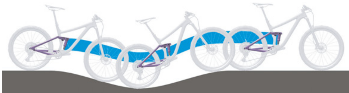
Rysunek 137: Optymalne działanie tylnego amortyzatora na pagórkowatym terenie
