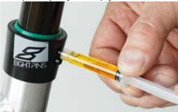
Rysunek 183: Smarowanie sztycy podsiodłowej eightpins
