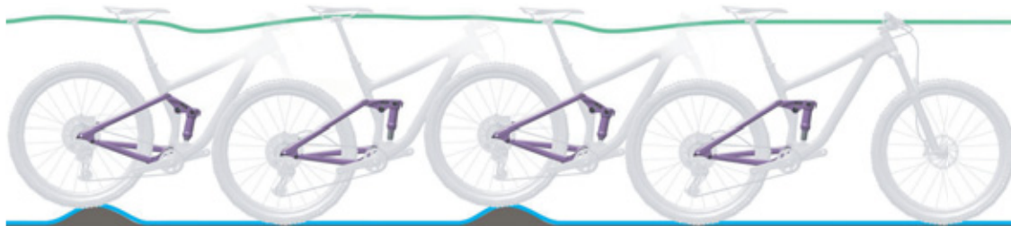
Rysunek 136: Optymalne działanie tylnego amortyzatora
