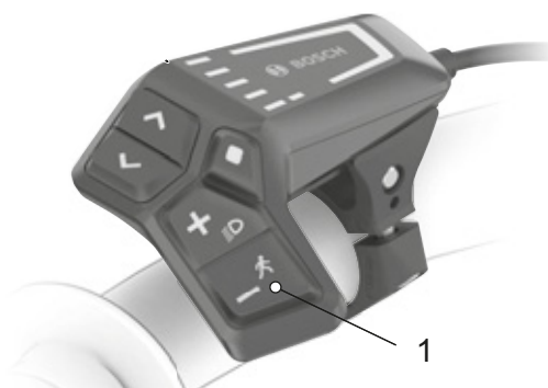
Rysunek 173: Położenie przycisku mechanizmu wspomagającego pchanie (1)
