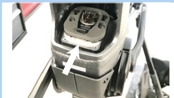
Rysunek 71: Zamontowane płytki adaptacyjne
