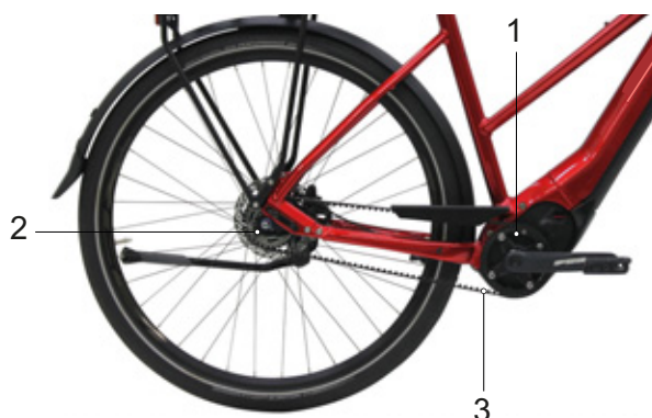
Rysunek 47: Schemat napędu paskowego
