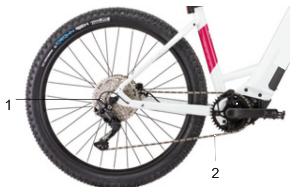
Rysunek 46: Schemat napędu łańcuchowego z przerzutką
