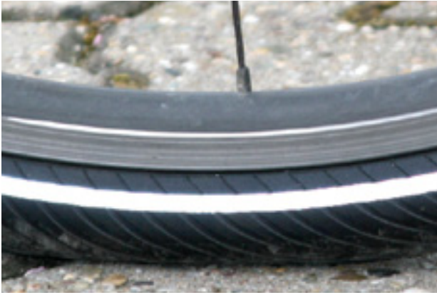
Rysunek 124: Prawidłowe ciśnienie w oponach. Opona prawie nie odkształca się pod wpływem ciężaru ciała
