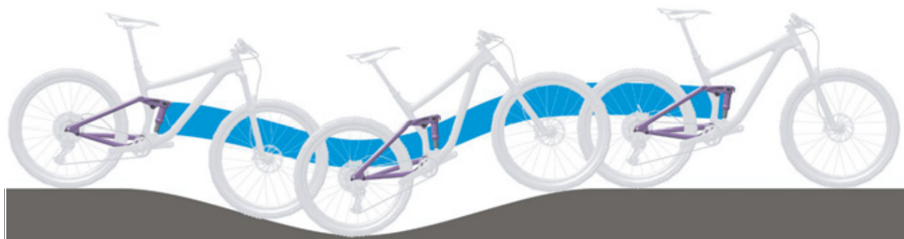
Rysunek 6: Optymalne działanie tylnego amortyzatora na pagórkowatym terenie
