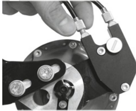
Rysunek 212: Wersje piasty ROHLOFF z zewnętrznym sterowaniem zmiany biegów mają regulator linki na przepustnicy kablowej, która znajduje się po lewej stronie
