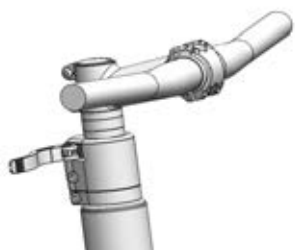
Rysunek 178: Przykład kierownicy typu All Up z otwartą dźwignią mocującą mostek
