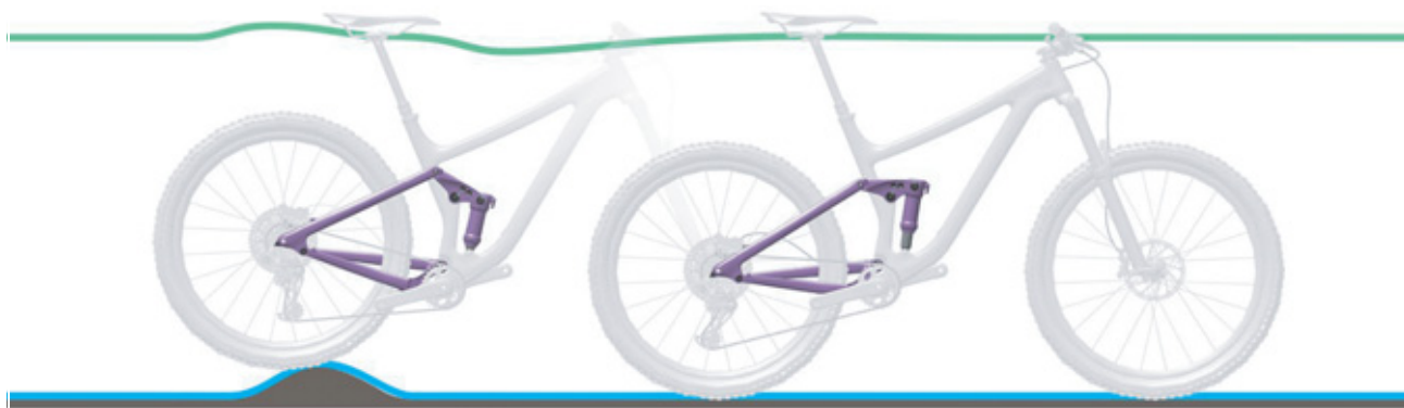
Rysunek 165: Optymalne działanie tylnego amortyzatora na nierównościach
