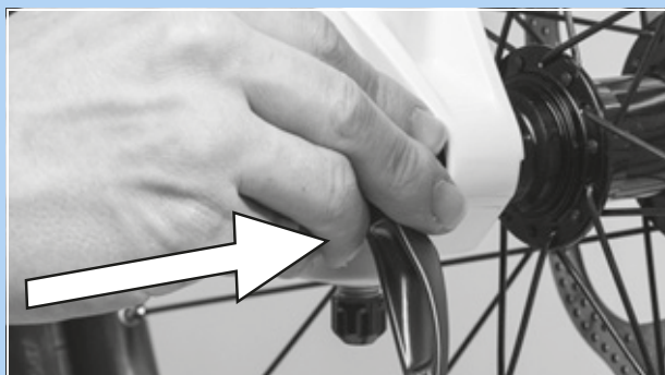
Rysunek 92: Wcisnąć zacisk szybkomocujący zgodnie z kierunkiem strzałki
