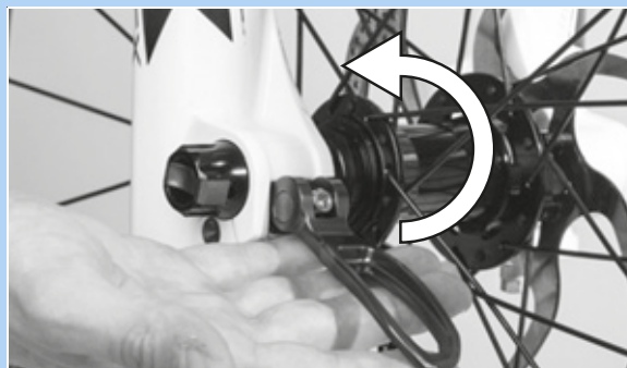
Rysunek 88: Docisnąć dźwignia zacisku szybkomocującego zgodnie z kierunkiem strzałki
