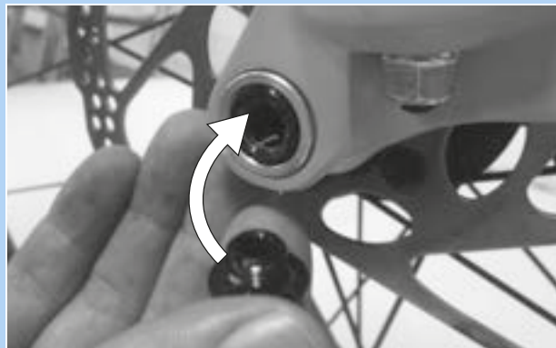
Rysunek 83: Wkładanie śruby zabezpieczającej
