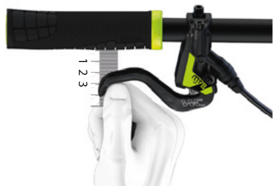
Rysunek 129: Ustawienie hamulca ręcznego
