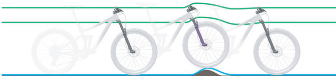
Rysunek 224: Zbyt twarde tłumienie widelca amortyzowanego na nierównościach
