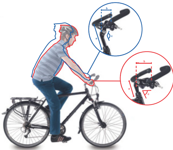
Rysunek 122: Pozycja roweru miejskiego (niebieski) i trekkingowego (czerwony) dzięki regulacji kąta nachylenia
