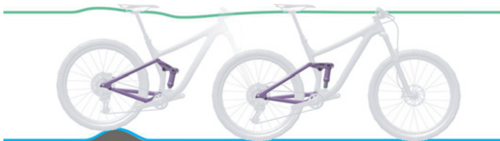
Rysunek 138: Optymalne działanie tylnego amortyzatora na nierównościach
