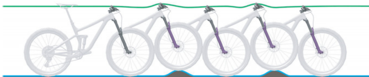
Rysunek 131: Optymalne działanie widelca
