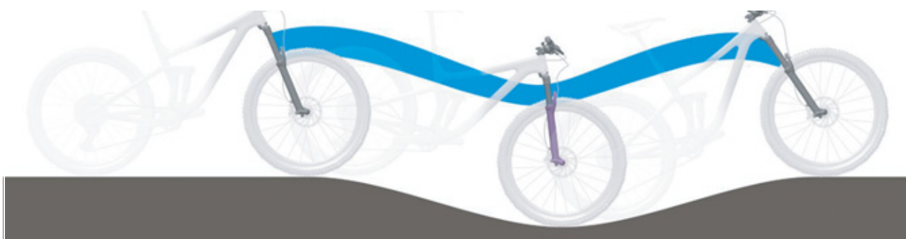
Rysunek 17: Optymalne działanie widełca na pagórkowatym terenie
