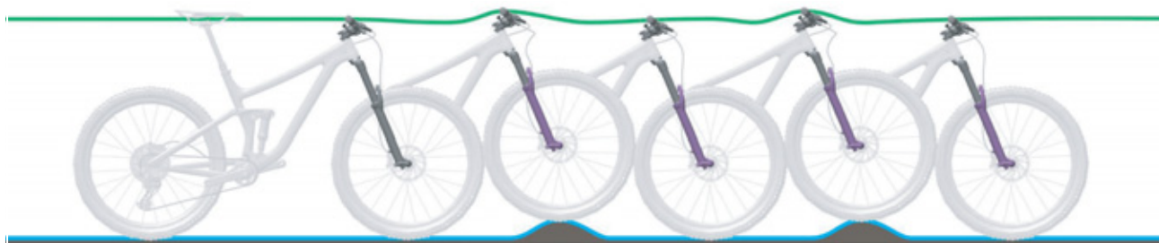
Rysunek 19: Optymalne działanie widelca
