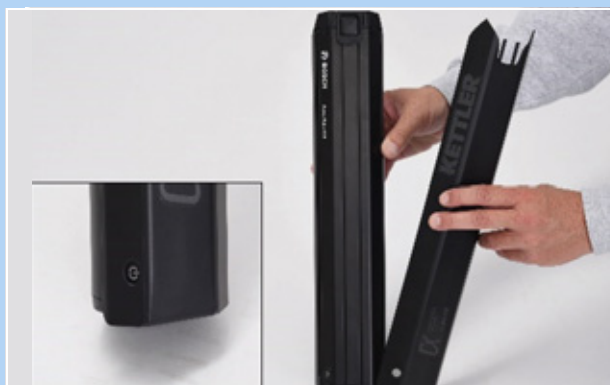
Rysunek 75: Wsuwanie pokrywy na akumulator
