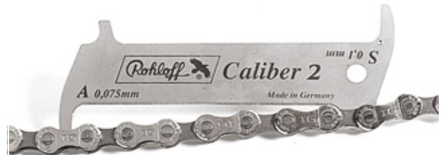
Rysunek 192: Przykładowy przymiar firmy ROHLOFF
