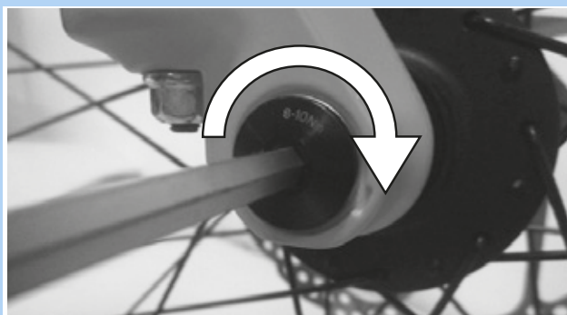
Rysunek 82: Dokręcić oś zgodnie z kierunkiem strzałki
