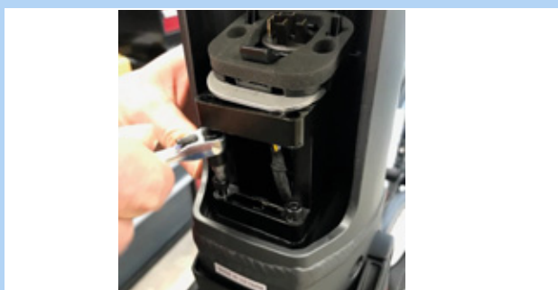
Rysunek 68: Wykręcanie śrub z łbem sześciokątnym 4 mm
