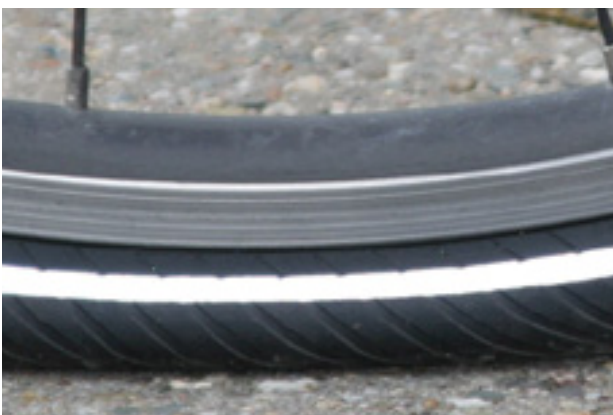
Rysunek 125: Zbyt niskie ciśnienie w oponie
