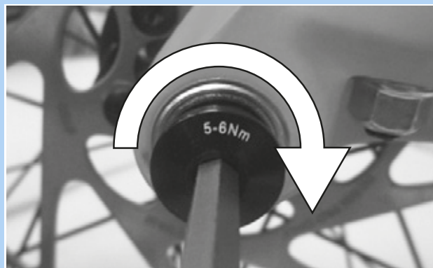
Rysunek 84: Sposób dokręcania śruby zabezpieczającej
