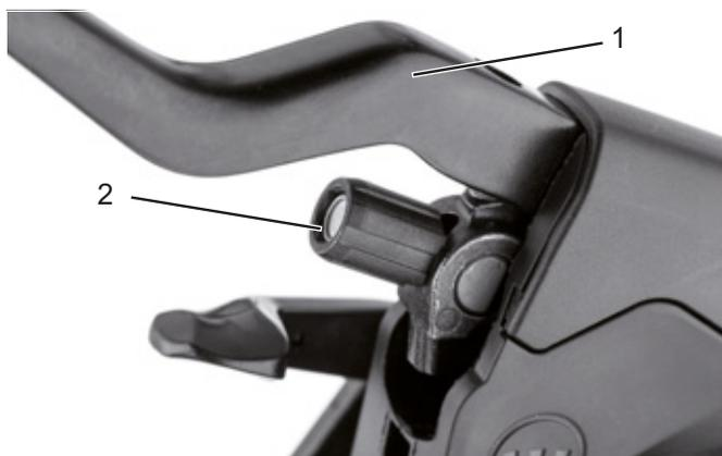
**Figura 81:** Leva del freno (1) del freno a pattino ad azionamento idraulico con vite di regolazione (2)
