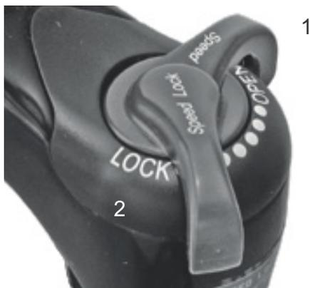
**Figura 63:** Regolatore della compressione Suntour con posizioni OPEN (1) e LOCK (2)
