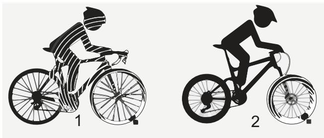
**Figura 4:** Bicicletta senza sospensione (1) e con sospensione (2) nel passaggio su un ostacolo
