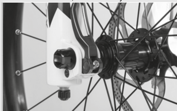
Rysunek 30: Optymalne położenie dźwigni mocującej
