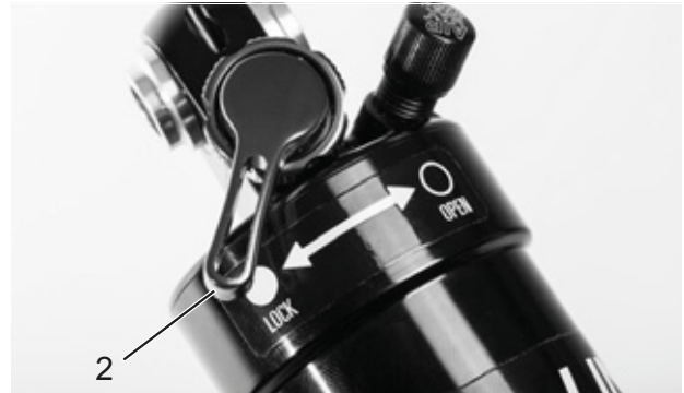
Rysunek 67: Nastawnik dobicia Suntour w pozycji zamkniętej (2)
