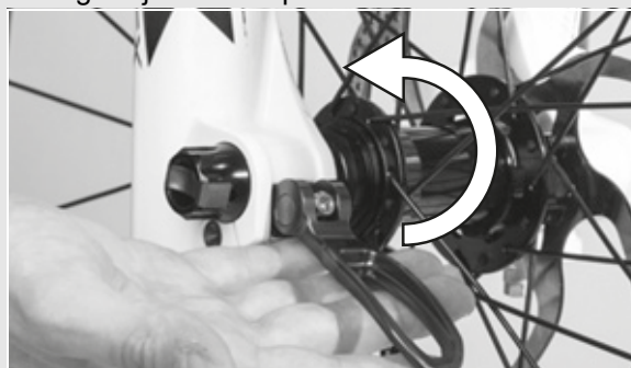
Rysunek 29: Sposób zabezpieczania dźwigni
