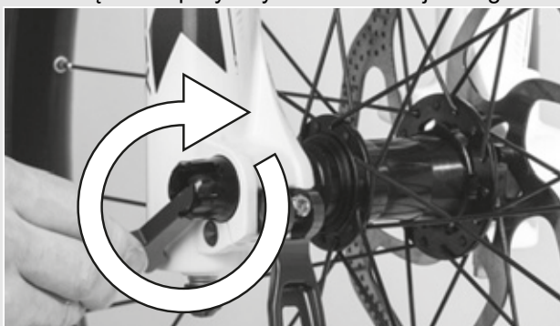
Rysunek 27: Sposób dokręcania osi
