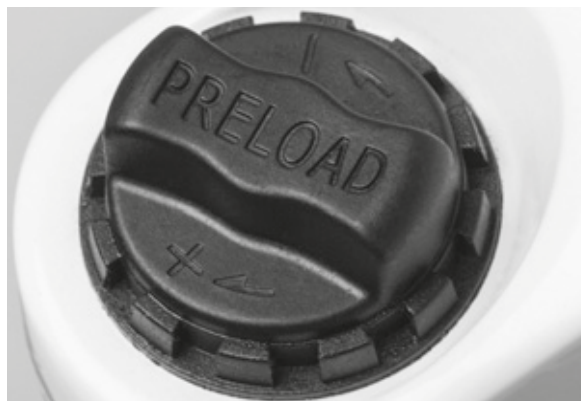
Rysunek 53: Pokrętło regulacyjne ujemnego skoku sprężyny, usytuowane na koronie widelca amortyzowanego
