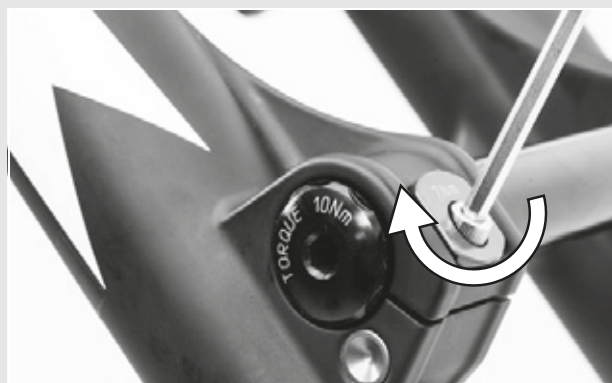
Rysunek 25: Sposób dokręcania osi
