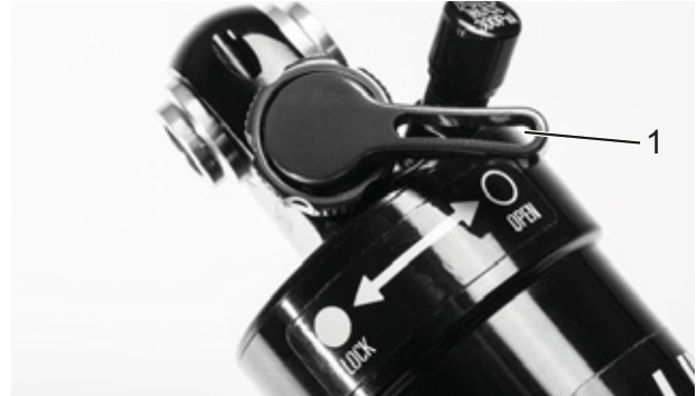
Rysunek 66: Nastawnik dobicia Suntour w pozycji otwartej (1)
