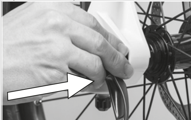
Rysunek 33: Wsuwanie zacisku szybko mocującego
