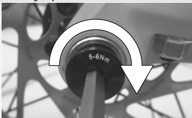
Rysunek 23: Sposób dokręcania śruby zabezpieczającej
