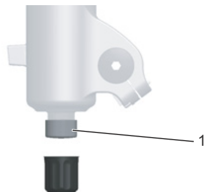
Rysunek 55: Nastawnik odbicia (1) FOX na widelcu
