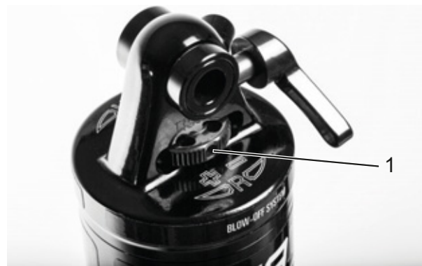
Rysunek 56: Nastawnik odbicia koła Suntour (1) na tylnym amortyzatorze
