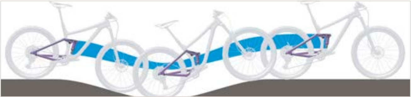
268 paveikslėlis. Ant kalno galinio amortizatoriaus amortizavimas per minkštas
