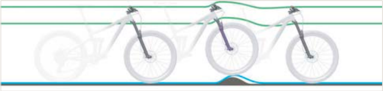
253 paveikslėlis. Per kietas amortizuojančių šakių slopinimas nelygumuose
