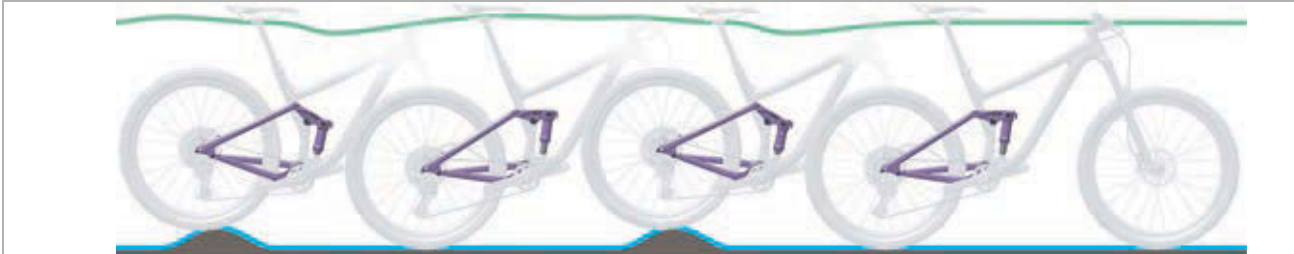
139 paveikslėlis. Optimali galinio amortizatoriaus važiavimo charakteristika
