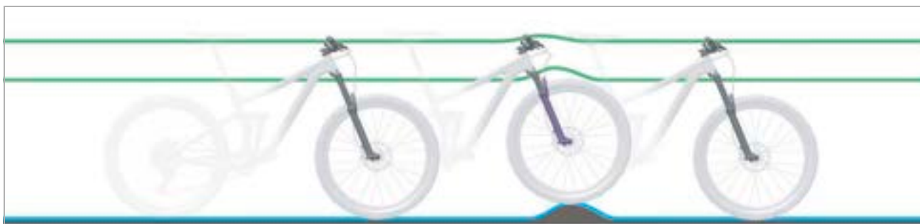
17 paveikslėlis. Optimali šakių važiavimo charakteristika nelygumuose
