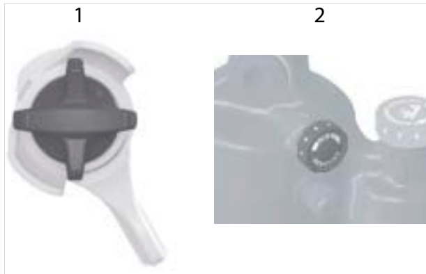
154 paveikslėlis. Atšokimo pakopos reguliatorius „Float DPS“ (1) ir „Float X“ (2)
