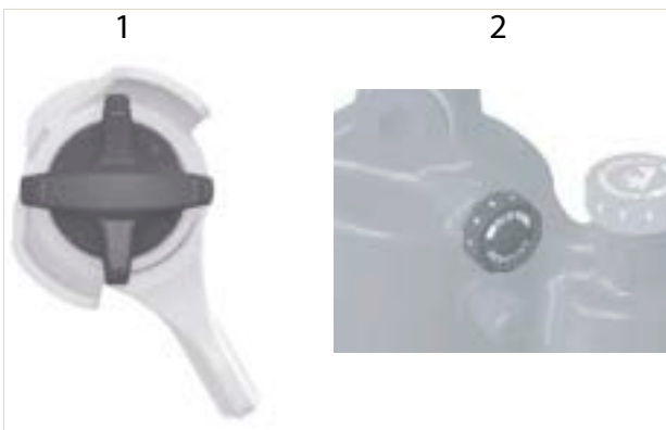
267 paveikslėlis. Atšokimo pakopos reguliatorius „Float DPS“ (1) ir „Float X“ (2)
