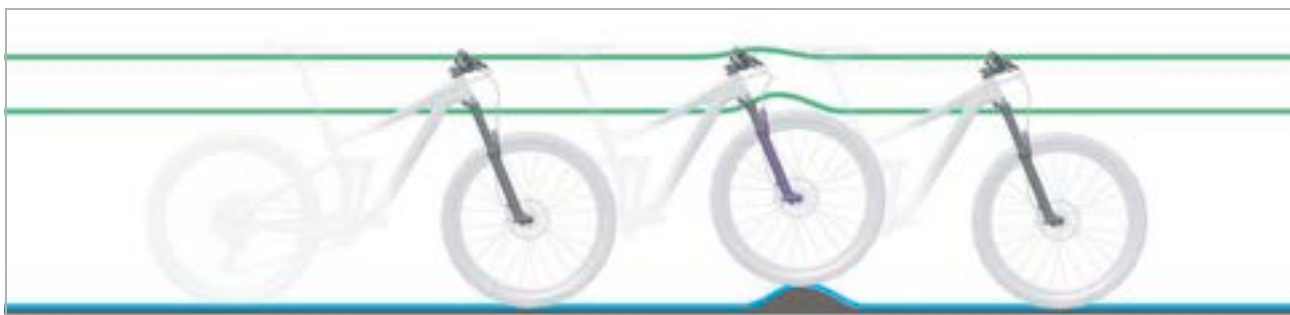
130 paveikslėlis. Optimali šakių važiavimo charakteristika nelygumuose
