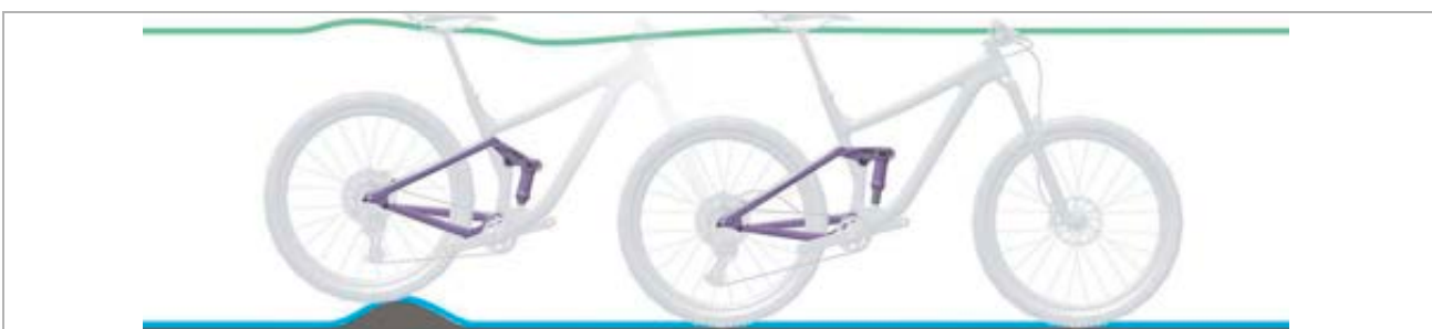
141 paveikslėlis. Optimali galinio amortizatoriaus važiavimo charakteristika nelygumuose
