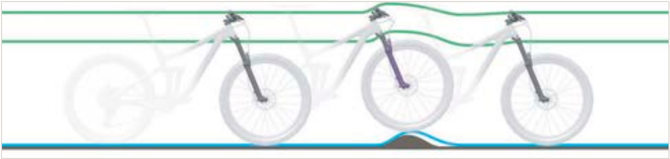
238 paveikslėlis. Per kietas amortizuojančių šakių slopinimas nelygumuose
