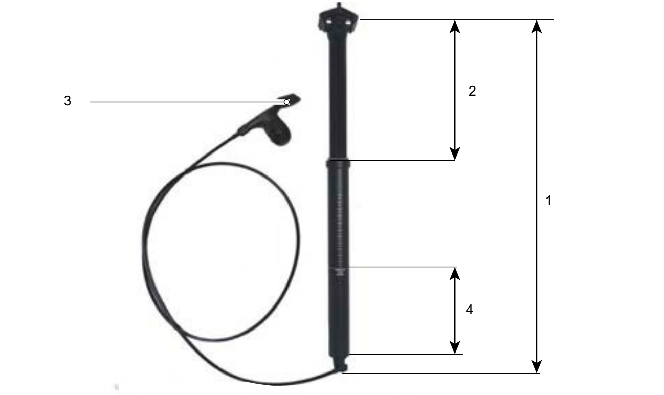
38 paveikslėlis. LIMOTEC A1 balnelio stovo konstrukcija ir matmenys
