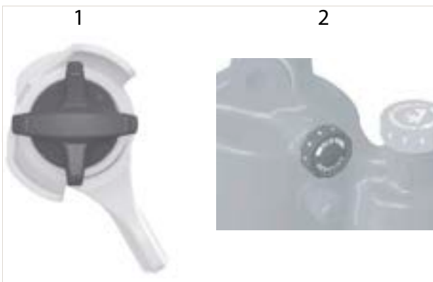
265 paveikslėlis. Atšokimo pakopos reguliatorius „Float DPS“ (1) ir „Float X“ (2)
