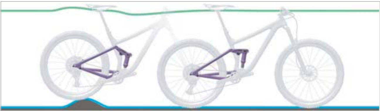
171 paveikslėlis. Optimali galinio amortizatoriaus važiavimo charakteristika nelygumuose
