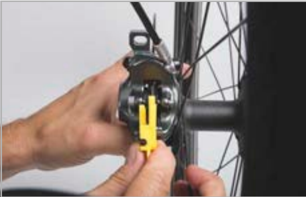
200 paveikslėlis. Naudodami transportavimo apsaugą patikrinkite sumontuotas stabdžių trinkeles
