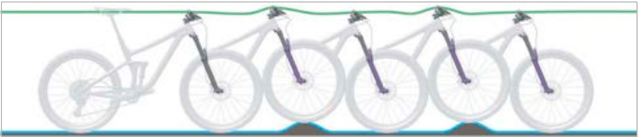
18 paveikslėlis. Optimali šakių važiavimo charakteristika
