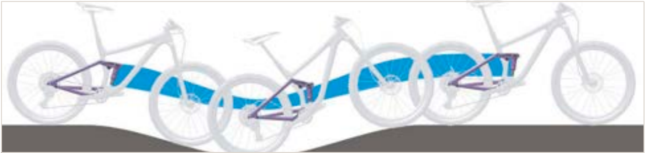
276 paveikslėlis. Ant kalno galinio amortizatoriaus amortizavimas per minkštas
