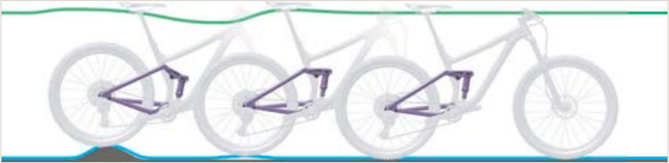
272 paveikslėlis. Per greitas galinio amortizatoriaus atšokimas
