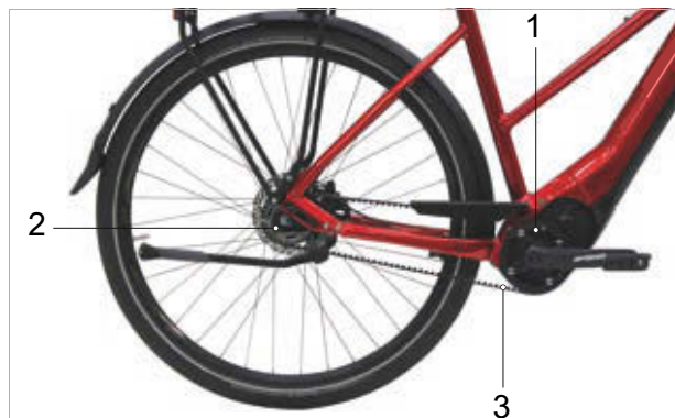
46 paveikslėlis. Diržinės pavaros schema
