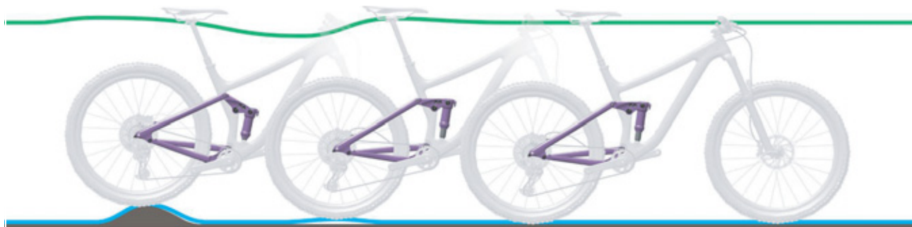
Figura 233: Descompresión demasiado rápida del amortiguador de la horquilla trasera
