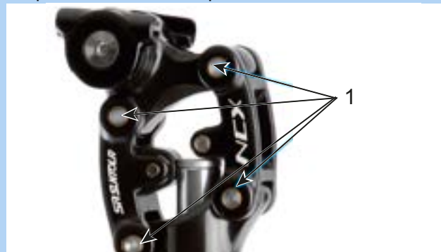
Figura 162: Puntos de lubricación de la tija de sillín de muelle SR Suntour
