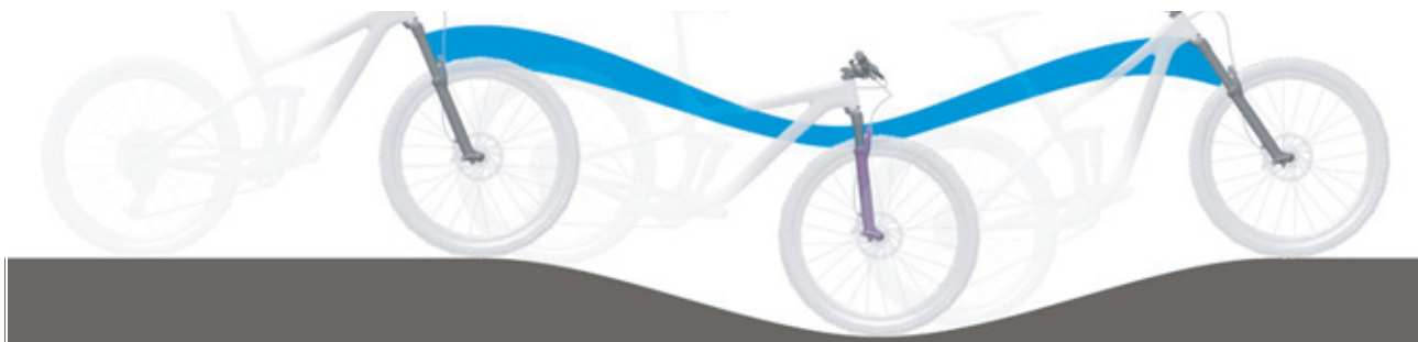
Figura 229: Suspensión de la horquilla de suspensión demasiado blanda en montaña
