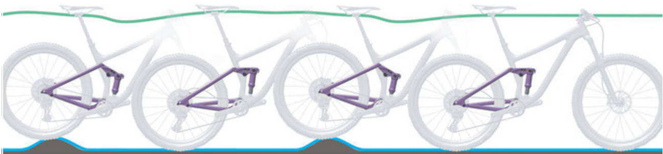
Figura 15: Condición óptima de marcha del amortiguador de la horquilla trasera
