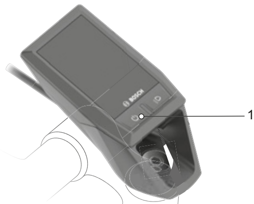
Figura 138: Posición del botón de conexión/desconexión (unidad de mando)
