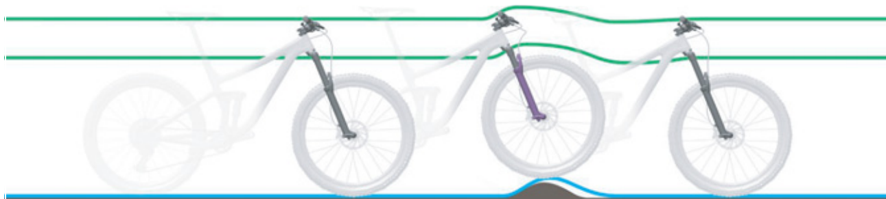
Figura 231: Amortiguación de la horquilla de suspensión demasiado dura en caso de irregularidades
