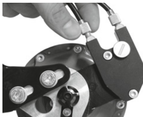
Figura 156: Las versiones de bujes Rohloff con activación de cambio externa tienen los dispositivos de ajuste de tensión en la caja de cables que se encuentra en el lado izquierdo
