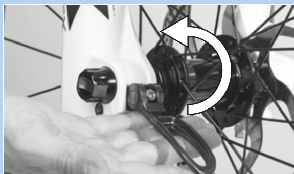
Figura 74: Presión de la palanca de cierre rápido en la dirección de la flecha
