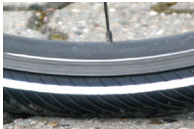
Figura 102: Presión de inflado correcta. La cubierta apenas está deformada bajo la carga del peso corporal
