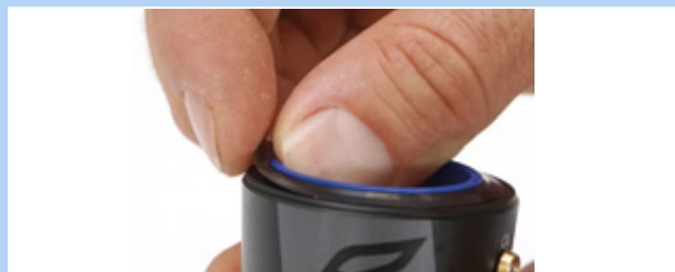
Figura 206: Retirada del anillo con falda de obturación
