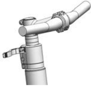
Figura 143: Ejemplo de All Up con palanca tensora de la potencia abierta
