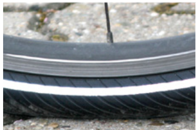
Figura 108: Presión de inflado correcta. La cubierta apenas está deformada bajo la carga del peso corporal
