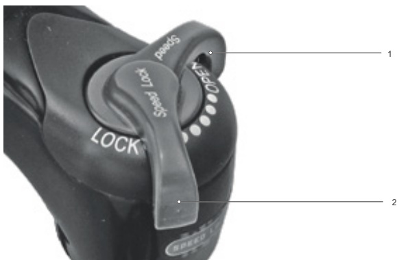
Figura 230: Ajuste para un regulador de niveles de presión más duro
