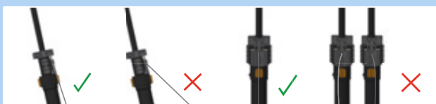
Figura 190: Cable Bowden correcto e incorrecto
