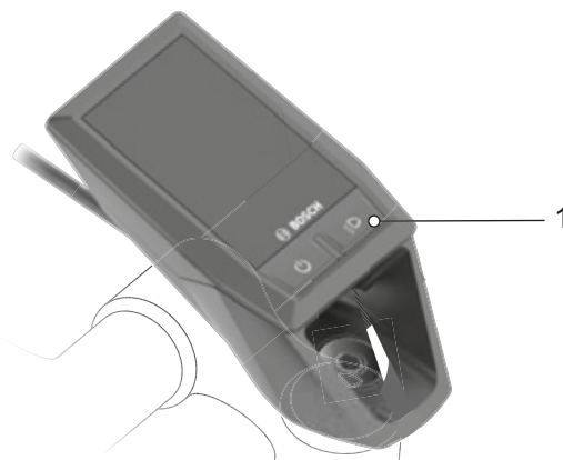
Figura 139: Posición del botón de la luz de marcha
