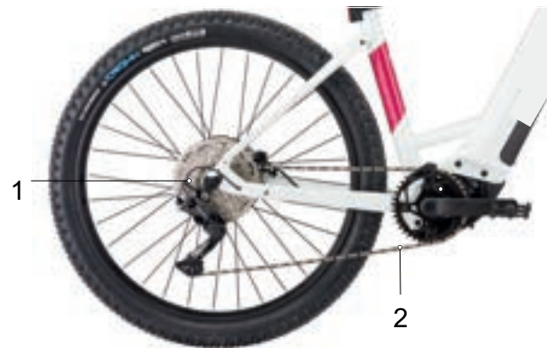
Abbildung 26: Schema Kettenantrieb mit Kettenschaltung
