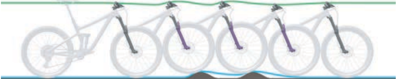
Abbildung 195: Zu langsames Ausfedern der Federgabel
