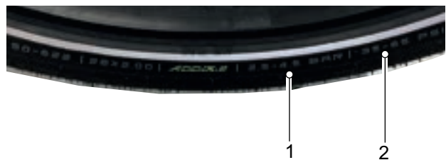
Abbildung 118: Fülldruck in bar (1) und psi (2)
