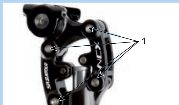
Abbildung 130: Schmierpunkte SR Suntour Feder-Sattelstütze
