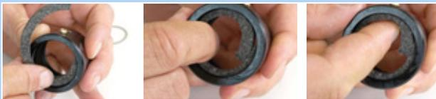
Figura 197: Applicazione dell'anello di feltro
