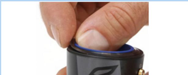
Figura 192: Estrazione dell'anello a labbro di tenuta
