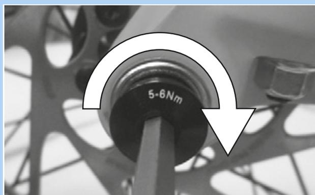
Figura 55: Serraggio della vite di sicurezza
