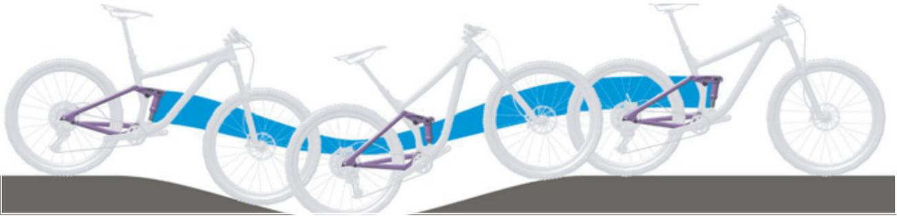
Figura 223: Sospensione dell'ammortizzatore del carro posteriore troppo morbida in salita
