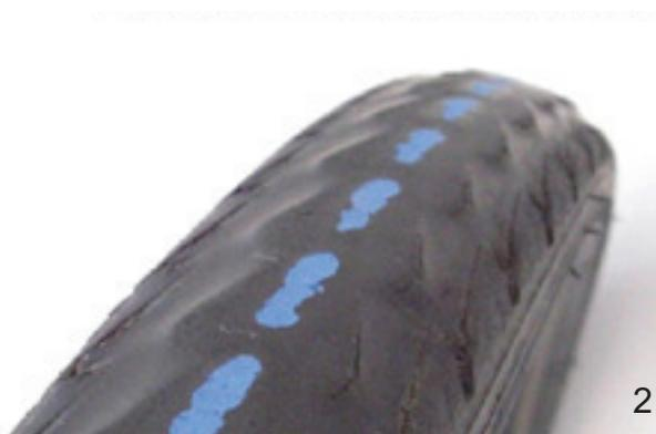
Figura 136: Pneumatico senza profilo ancora utilizzabile (1) e pneumatico con protezione contro le forature in vista (2) che deve essere sostituito
