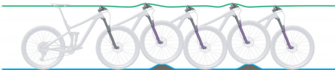
Figura 98: Comportamento di marcia ottimale della forcella
