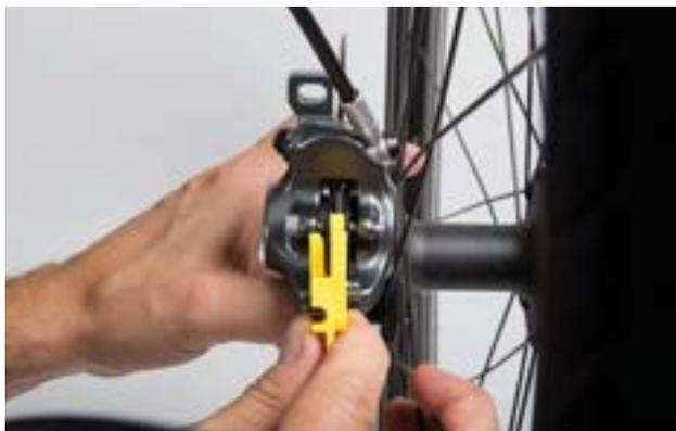
Figura 138: Controllo della guarnizione del freno nello stato montato mediante la sicura di trasporto
