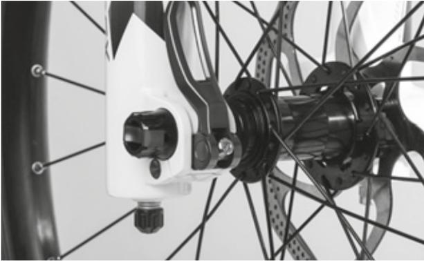
Figura 60: Corretta posizione della leva di serraggio
