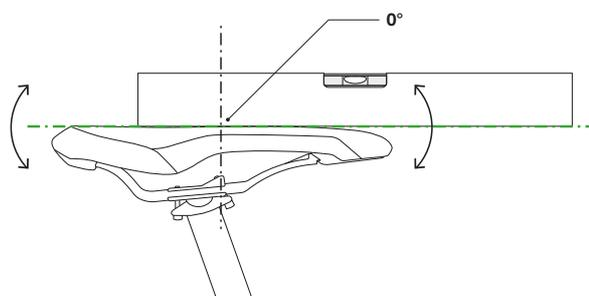
Figura 77: Sella in posizione orizzontale con angolo di inclinazione di 0° del centro della sella
