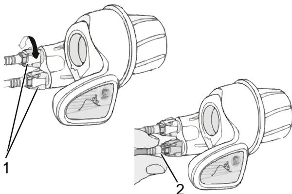
Figura 145: Interruttore a manopola del cambio con boccole di regolazione (1) e gioco della boccola del cambio (2)
