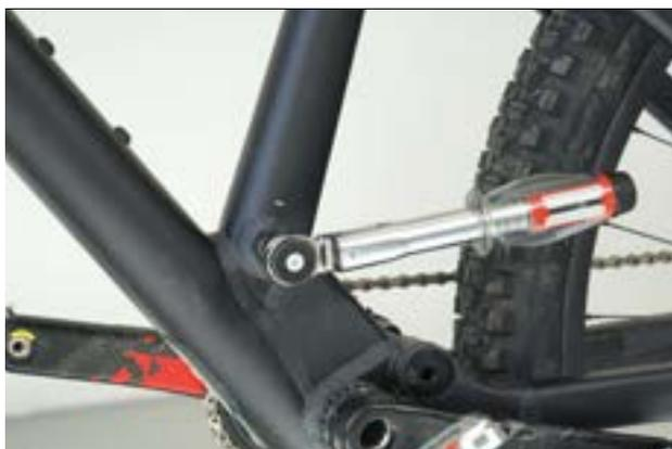
Figura 71: Serraggio dell'asse del canotto reggisella
