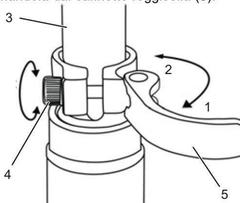
Figura 73: Apertura del bloccaggio rapido del canotto reggisella
