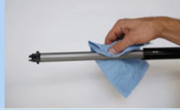
Figura 202: Pulizia della scanalatura di guida longitudinale
