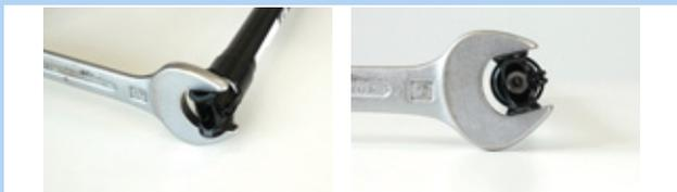
Figura 170: Bloccaggio per impedire la rotazione
