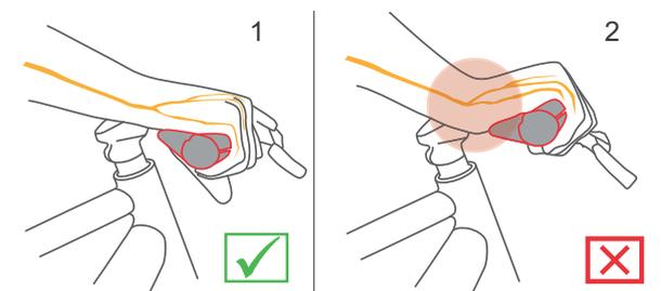
Figura 86: Posizione corretta (1) ed errata (2) della manopola
