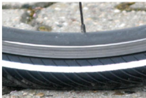
Figura 87: Corretta pressione di gonfiaggio. Lo pneumatico quasi non si deforma sotto il peso corporeo
