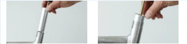
Figura 180: Inserimento del tubo del maniccotto scorrevole nel canotto della sella
