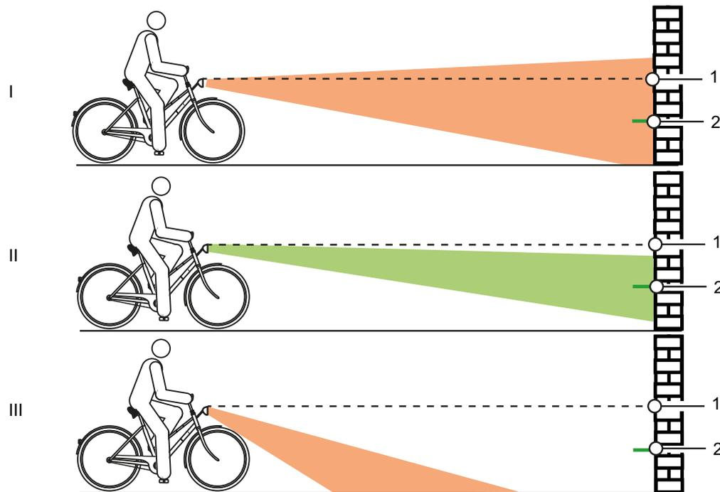
Figura 139: Luce regolata a un'altezza eccessiva (1), correttamente (2) e a un'altezza insufficiente (3)
