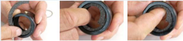
Figura 162: Applicazione dell'anello di feltro
