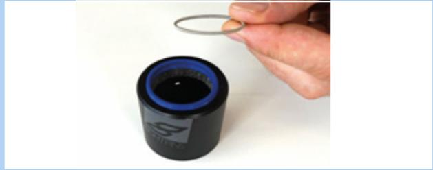
Figura 158: Anello elastico smontato
