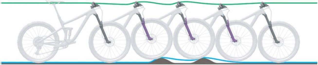
Figura 213: Corsa di estensione troppo lenta della forcella ammortizzata
