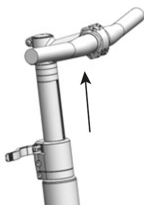
Figura 81: Sollevamento della leva di sicurezza, esempio All Up
