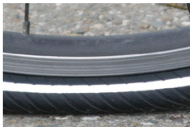
Figura 88: Pressione di gonfiaggio insufficiente
