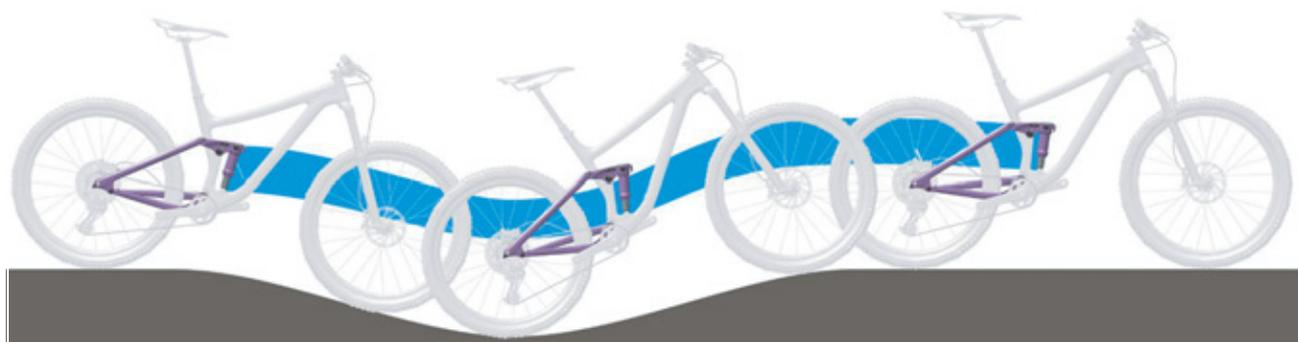
Figura 20: Comportamento di marcia ottimale dell'ammortizzatore del carro posteriore su un terreno con dossi
