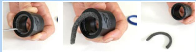
Figura 160: Rimozione dell'anello di feltro
