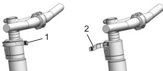
Figura 80: Leva di serraggio dell'attacco manubrio chiusa (1) e aperta (2), esempio All Up
