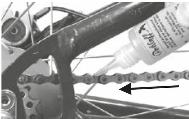
Figura 133: Lubrificazione della catena
