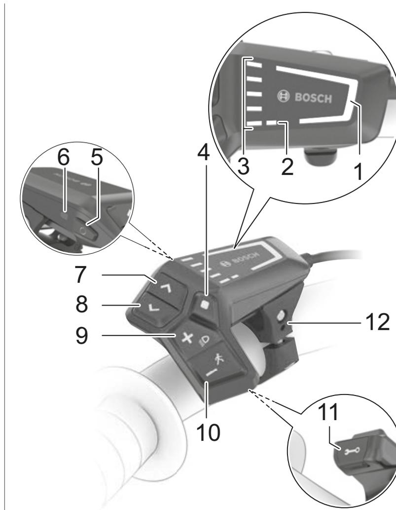
Figura 40: Schema del terminale di comando BOSCH LED Remote
