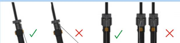
Figura 176: Cavo meccanico corretto ed errato
