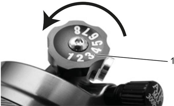
Figura 224: Regolatore dello stadio di compressione Suntour (1) sull'ammortizzatore del carro posteriore
