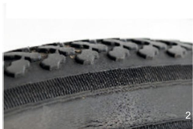
Figura 137: Esempi di crepe da fatica (1) e da invecchiamento (2)
