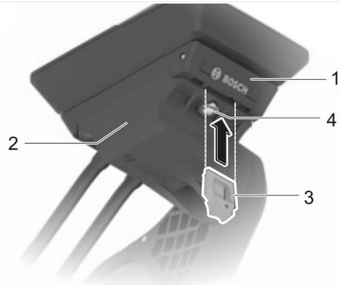
Figura 108: Ubicazione della vite della serie sterzo
