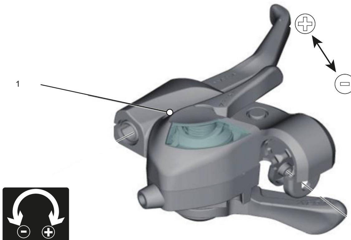
Figura 95: Posizione della vite di regolazione (1)
