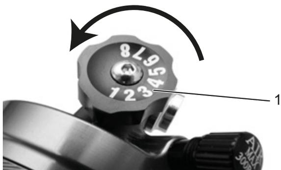
Figura 103: Regolatore dello stadio di compressione Suntour (1) sull'ammortizzatore del carro posteriore
