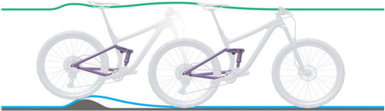
Figura 225: Smorzamento troppo duro dell'ammortizzatore del carro posteriore su asperità
