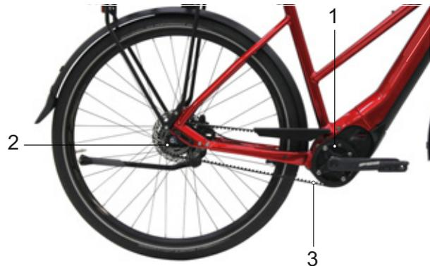
Figura 33: Schema della trasmissione a cinghia
