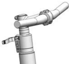
Figura 129: Esempio: All Up con leva di serraggio dell'attacco manubrio aperta
