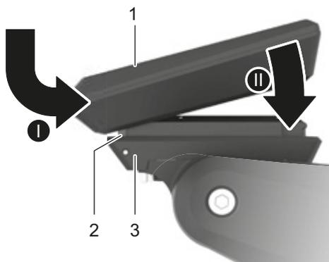
Figura 107: Montaggio del display
