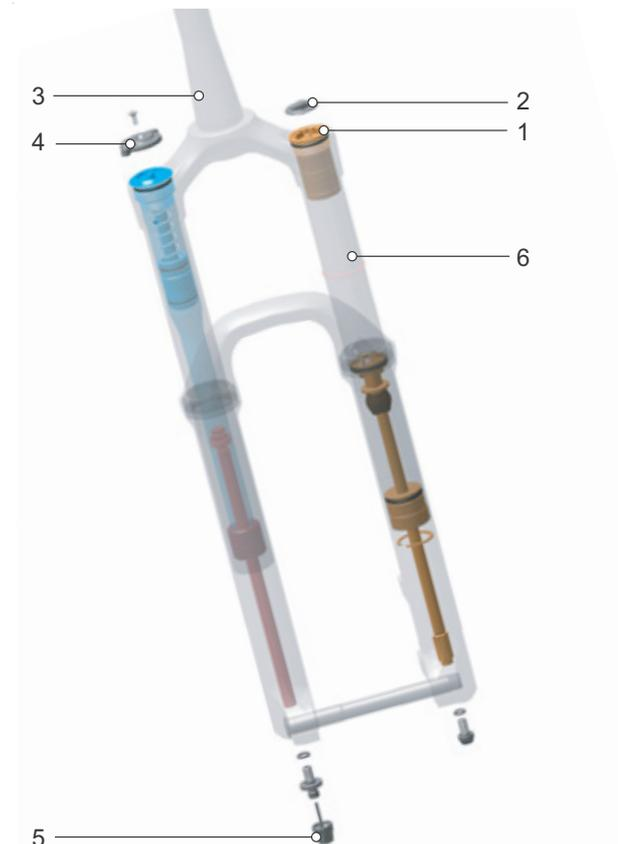
Figura 14: Struttura interna della forcella ammortizzata pneumatica
