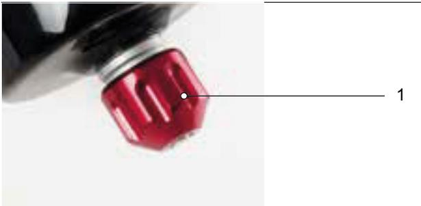
Figura 214: Vite del rebound Suntour (1)
