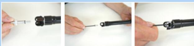
Figura 168: Fissaggio del coperchio della valvola della cartuccia
