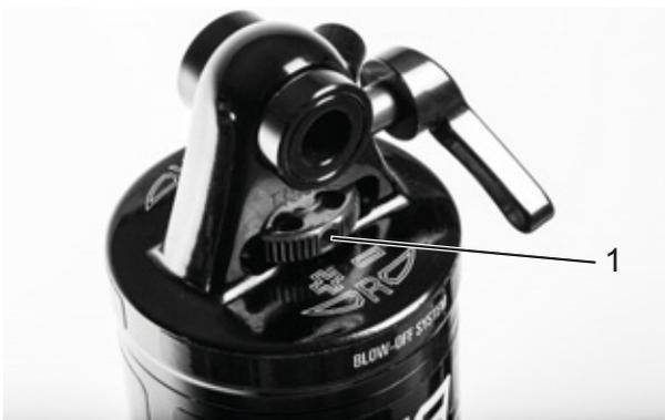
Figura 222: Regolatore del rebound Suntour (1) sull'ammortizzatore del carro posteriore
