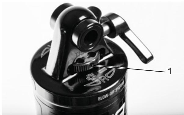
Figura 101: Regolatore del rebound Suntour (1) sull'ammortizzatore del carro posteriore
