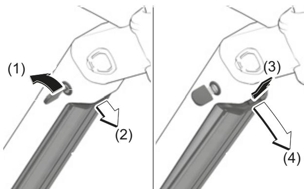
Figura 118: Smontaggio della batteria integrata
