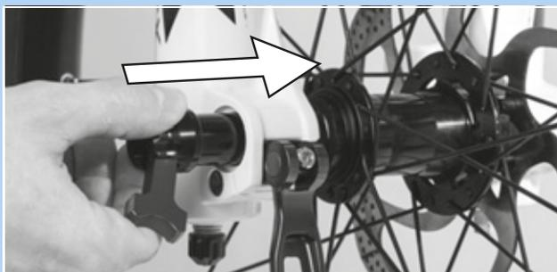
Figura 56: Inserimento del perno passante nel verso della freccia
