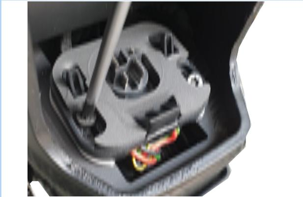
Figura 47: Svitamento delle viti del portabatteria
