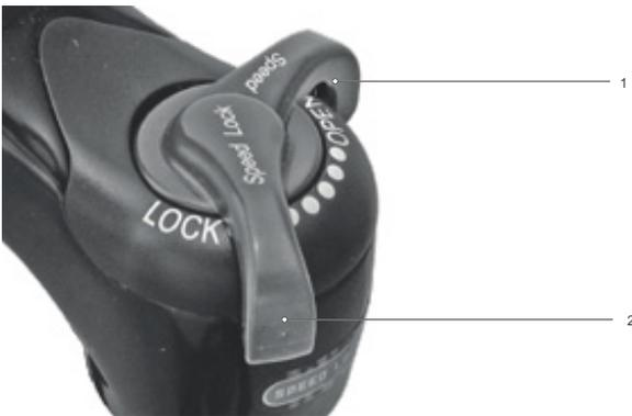
Figura 216: Regolazione più rigida del regolatore dello stadio di compressione
