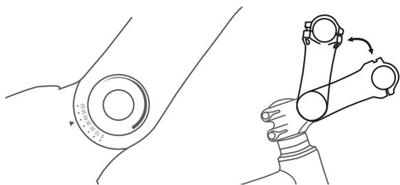
Figura 84: Differenti versioni di attacchi manubrio con angolazione variabile
