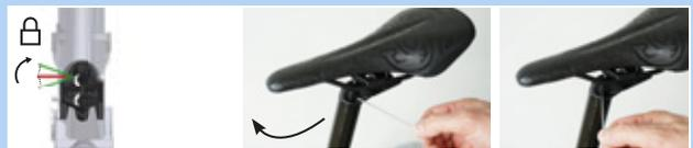
Figura 186: Chiusura della regolazione in altezza
