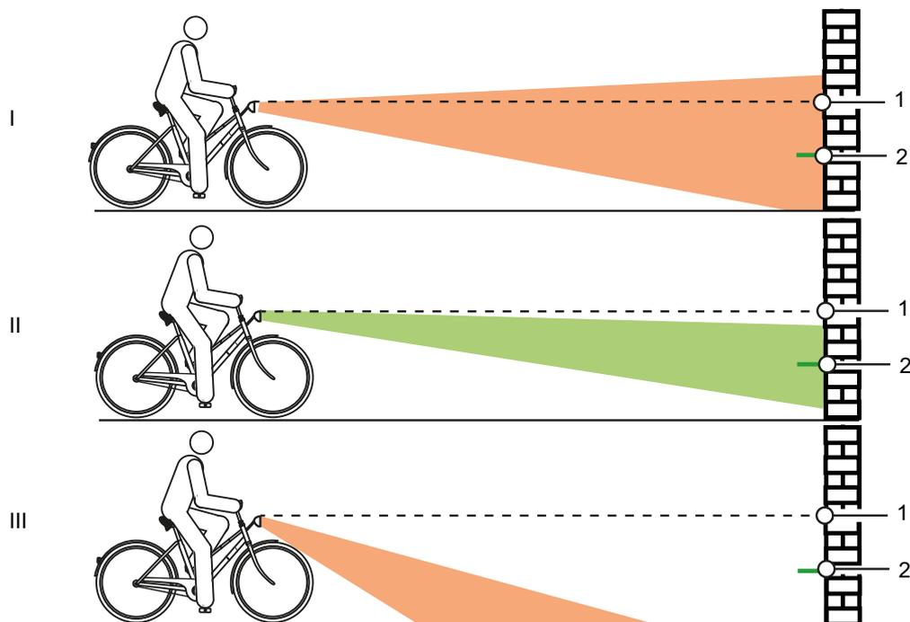
Figura 106: Luce regolata a un'altezza eccessiva (1), correttamente (2) e a un'altezza insufficiente (3)
