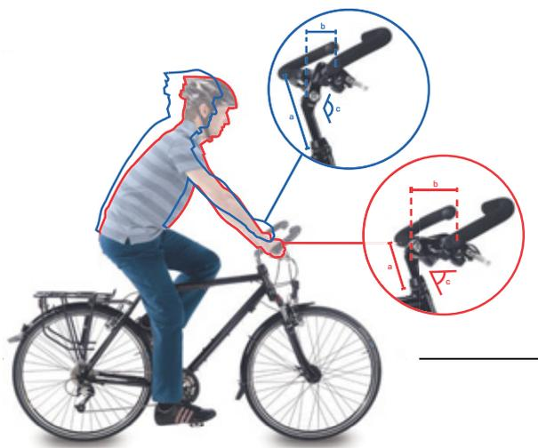
Figura 85: Bicicletta da città (blu) e bicicletta da trekking (rosso) tramite modifica dell'angolo
