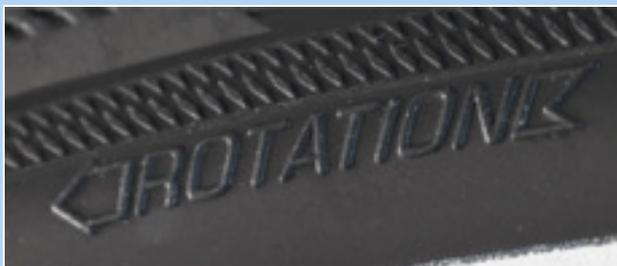
Figura 50: Freccia del senso di rotazione
