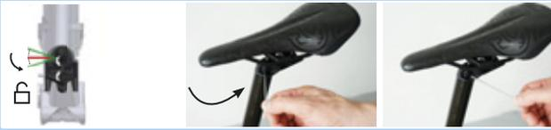
Figura 149: Posizionamento dell'azionamento della regolazione in altezza in posizione orizzontale
