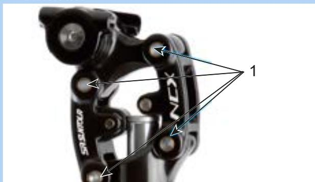
Figura 148: Punti di lubrificazione del cannotto reggisella ammortizzato SR Suntour
