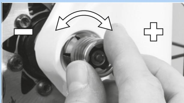
Figura 64: Regolazione del serraggio
