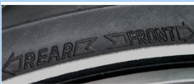
Figura 51: Freccia del senso di rotazione su pneumatici MTB
