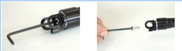
Figura 169: Svitamento del cappuccio della valvola
