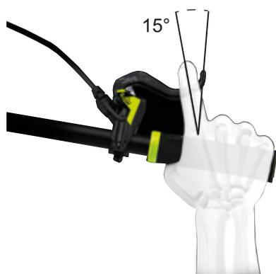
Figura 89: Posizione della leva del freno
