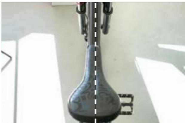
Figura 70: Posizionamento della sella in direzione di marcia
