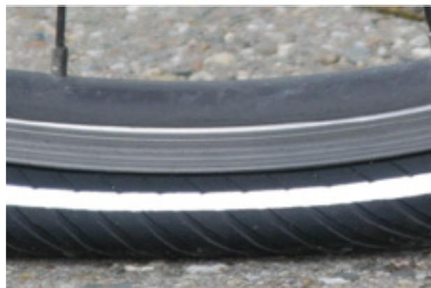
Figura 94: Pressione di gonfiaggio insufficiente
