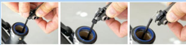
Figura 190: Rimozione del cavo meccanico
