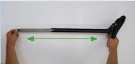
Figura 201: Estrazione completa del tubo del canotto reggisella
