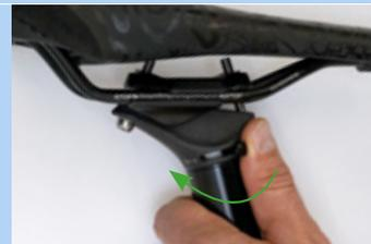
Figura 205: Chiusura della regolazione in altezza
