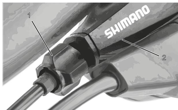
Figura 143: Boccola di regolazione (1) del cambio azionato da cavo singolo con scatola della leva del cambio (2), esempio
