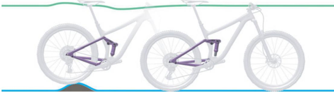
Figura 17: Comportamento di marcia ottimale dell'ammortizzatore del carro posteriore su asperità
