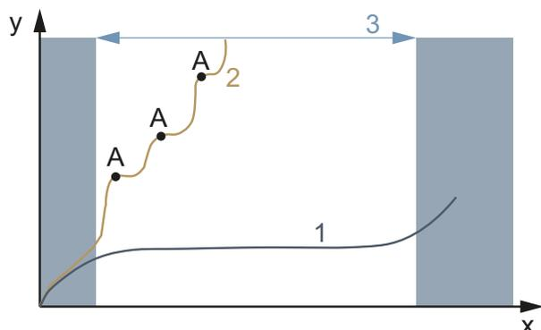
Figura 132: Diagramma dell'usura, asportazione di materiale (y) in funzione della durata di funzionamento (x)
