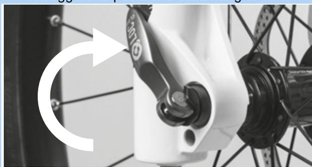
Figura 65: Chiusura del bloccaggio rapido
