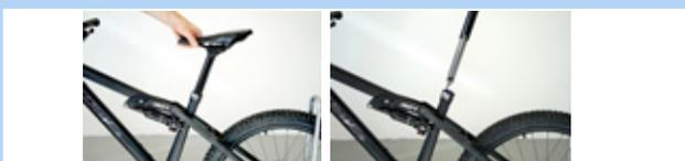
Figura 189: Rimozione del cannotto reggisella
