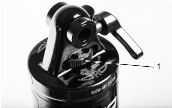
Figura 220: Regolatore del rebound Suntour (1) sull'ammortizzatore del carro posteriore
