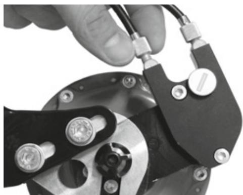
Figura 142: Le versioni del mozzo Rohloff con comando esterno del cambio hanno i regolatori del tensionamento sulla scatola dei cavi situata sul lato sinistro
