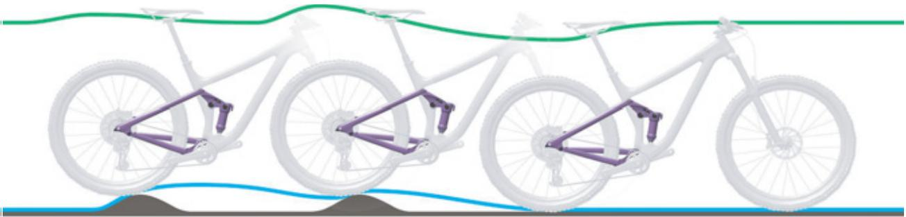
Figura 221: Corsa di estensione troppo lenta dell'ammortizzatore del carro posteriore
