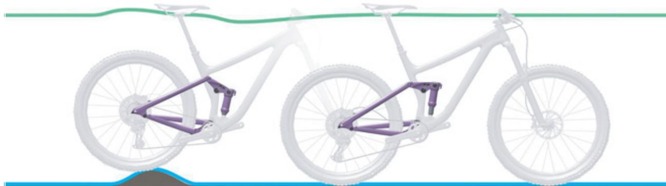
Figura 102: Comportamento di marcia ottimale dell'ammortizzatore del carro posteriore su asperità
