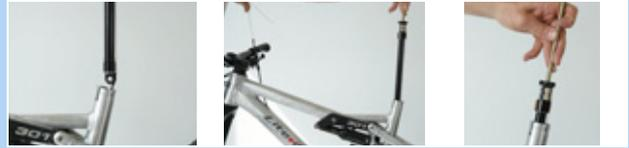
Figura 177: Fissaggio del coperchio della valvola della cartuccia
