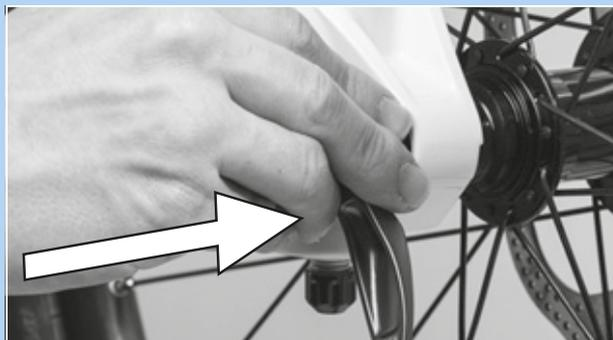
Figura 63: Inserimento del bloccaggio rapido nel verso della freccia
