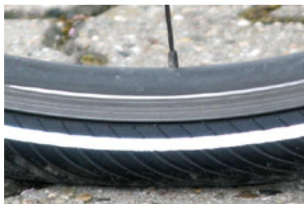
Figura 93: Corretta pressione di gonfiaggio. Lo pneumatico quasi non si deforma sotto il peso corporeo
