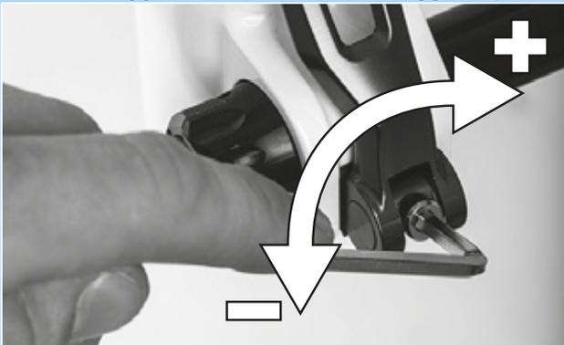
Figura 147: Regolazione della forza di serraggio del bloccaggio rapido
