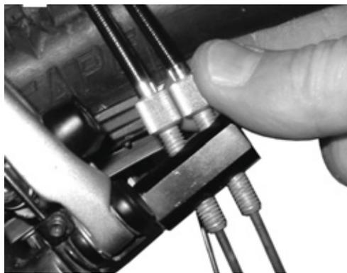
Figura 141: Le versioni del mozzo Rohloff con comando interno del cambio hanno i regolatori del tensionamento sul controsupporto di tensionamento
