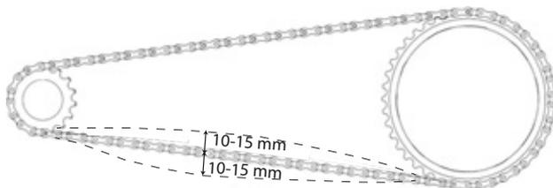
Figura 140: Controllo della tensione della catena
