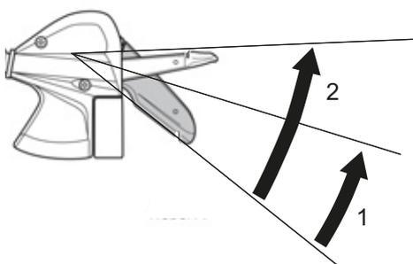
Figura 127: Cambio rapporto con la leva A, esempio cambio SL-M315
