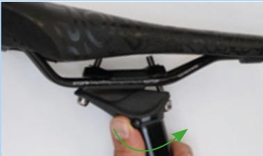
Figura 200: Apertura della regolazione in altezza
