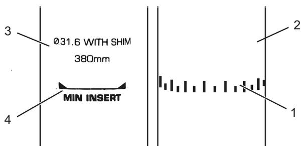
Figura 74: Particolare dei cannotti reggisella, esempi di segno indicante la minima profondità di inserimento
