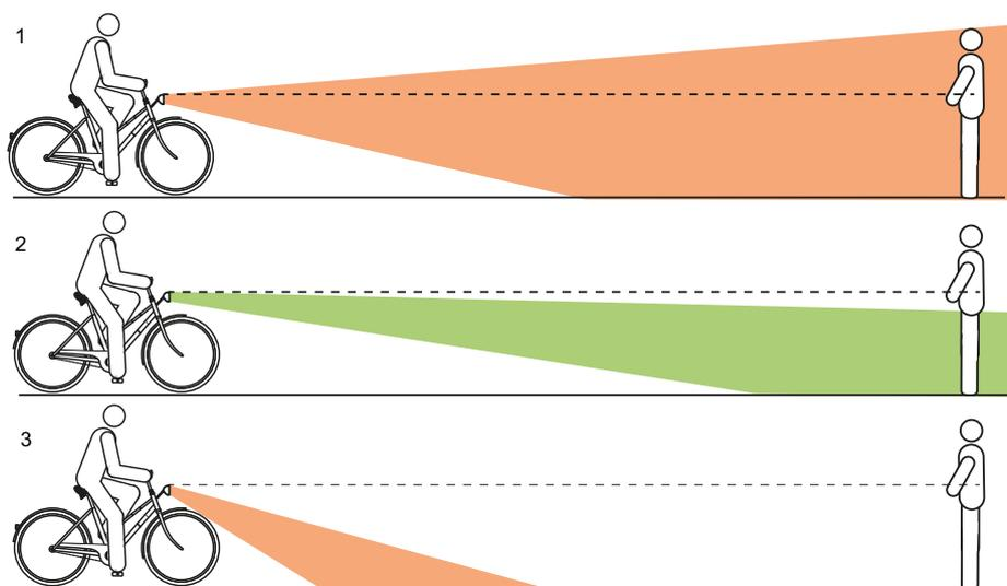
Figura 104: Luce regolata a un'altezza eccessiva (1), correttamente (2) e a un'altezza insufficiente (3)
