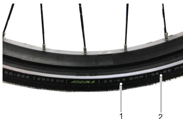
Figura 135: Pressione di gonfiaggio in bar (1) e in psi (2)
