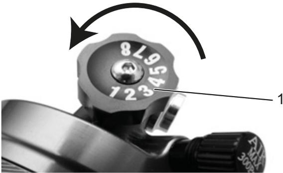
Figura 226: Regolatore dello stadio di compressione Suntour (1) sull'ammortizzatore del carro posteriore
