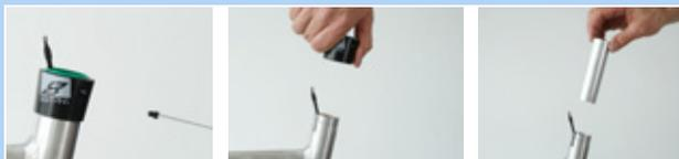
Figura 191: Smontaggio della boccola esterna e del manicotto scorrevole
