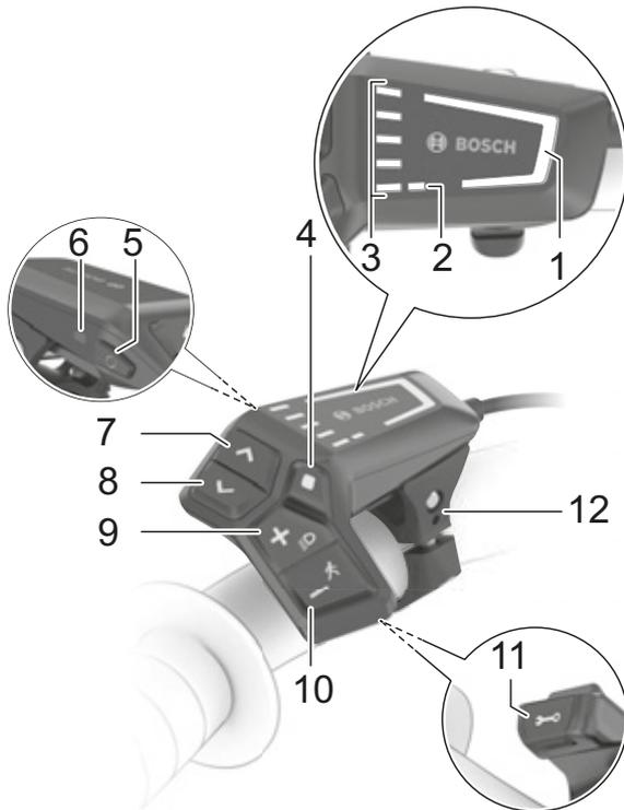
Figura 121: Schema del terminale di comando BOSCH LED Remote
