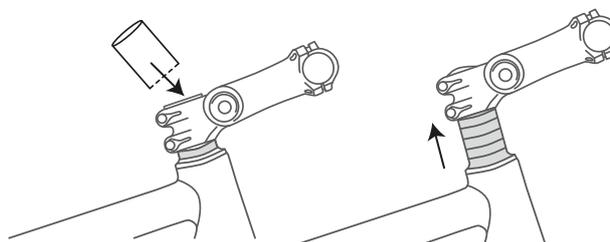
Figura 83: Aumento dell'altezza dell'attacco manubrio ahead tramite montaggio di distanziatori ad anello (spaziatori)
