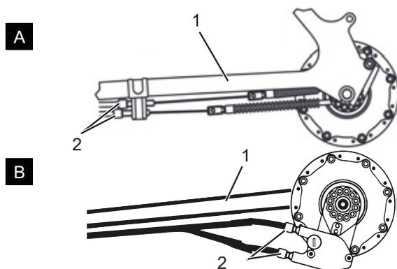
Figura 144: Boccole di regolazione (2) di due versioni alternative (A e B) di un cambio azionato da cavo doppio sul fodero orizzontale (1)
