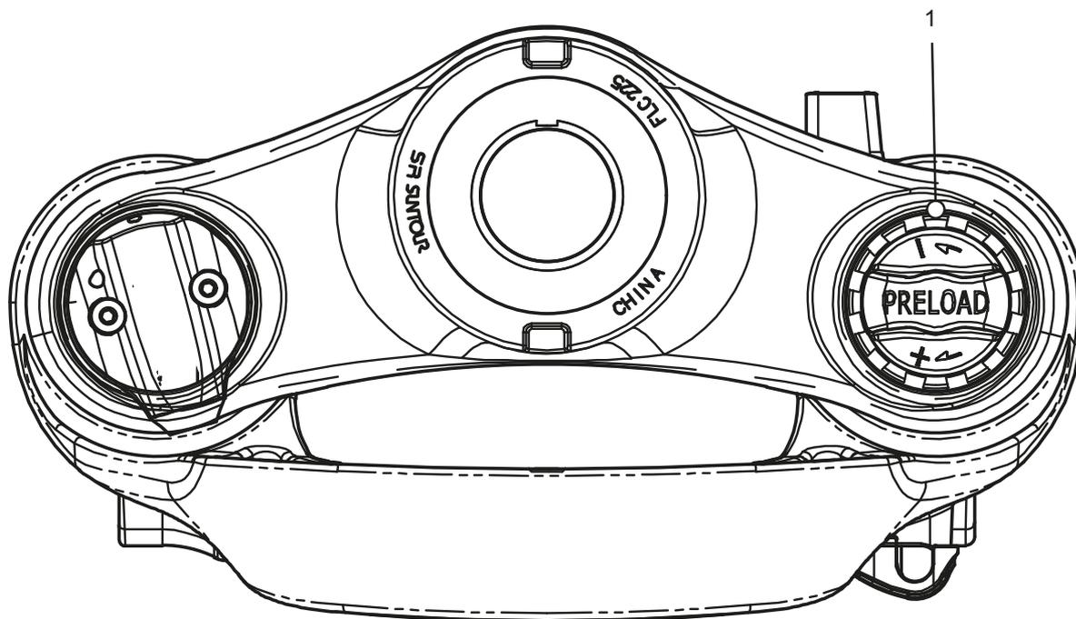
Figura 96: Manopola di regolazione della SAG (1) sulla corona della forcella ammortizzata
