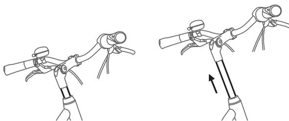
Figura 82: Regolazione dell'altezza dell'attacco manubrio a canotto
