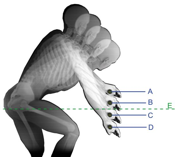
Figura 90: Esempio: 4 altezze diverse del manubrio (A, B, C e D) e altezza della sella (E).
