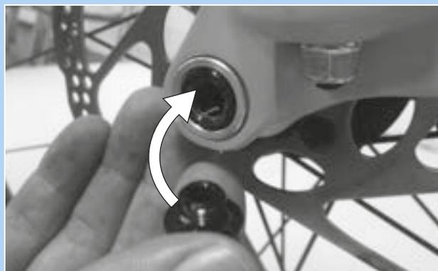
Figura 54: Applicazione della leva del bloccaggio rapido nel perno
