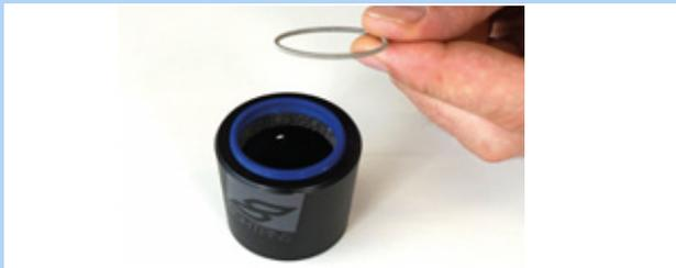
Figura 193: Anello elastico smontato
