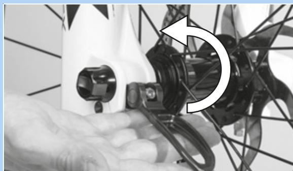
Figura 59: Spinta della leva del bloccaggio rapido nel verso della freccia
