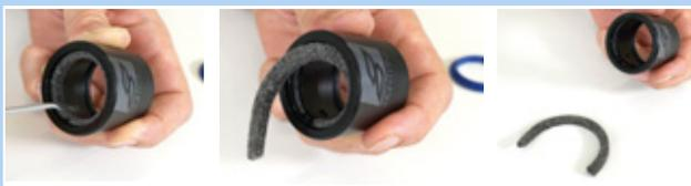
Figura 195: Rimozione dell'anello di feltro
