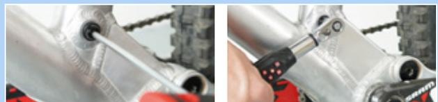
Figura 179: Fissaggio del perno Postpin
