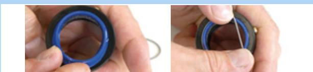
Figura 198: Applicazione e fissaggio del parapolvere
