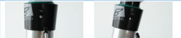
Figura 182: Fissaggio della boccola esterna
