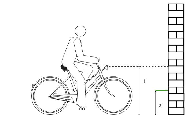
Figura 105: Altezza del fanale anteriore (1) e metà altezza del fanale (2)
