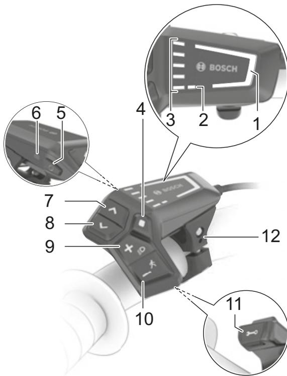
Figura 110: Schema del terminale di comando BOSCH LED Remote
