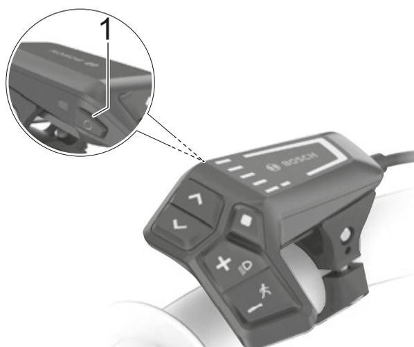
Figura 120: Ubicazione del tasto On/Off sul BOSCH LED Remote
