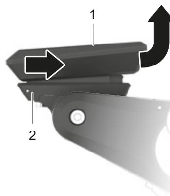
Figura 109: Smontaggio del computer di bordo
