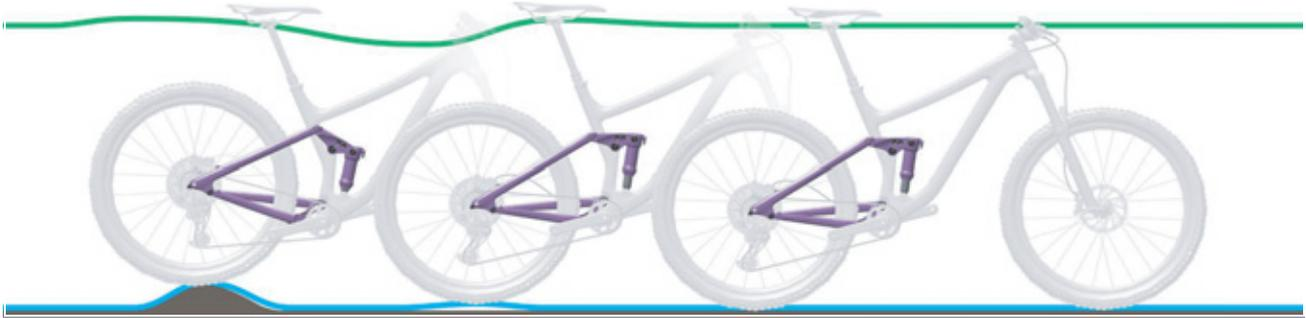
Figura 219: Corsa di estensione troppo veloce dell'ammortizzatore del carro posteriore
