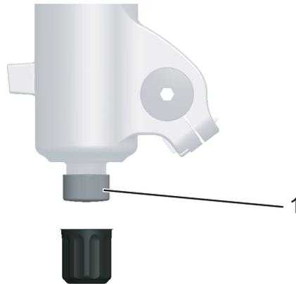
Illustration 51 : Dispositif de réglage de la détente FOX (1) sur la fourche
