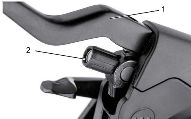
**Illustration 81 :** Levier de frein (1) du frein de jante à actionnement hydraulique avec vis de réglage (2)
