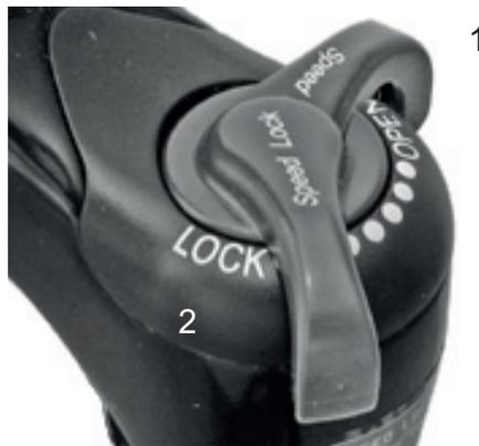
**Illustration 50 :** Dispositif de réglage de la compression Suntour avec les positions OPEN (1) et LOCK (2)
