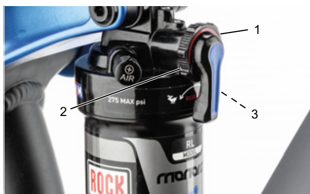
Figura 90: Ajuste de la dureza del amortiguador de niveles de tracción en la rueda de ajuste (1) del amortiguador de la horquilla trasera
