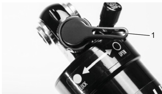
Figura 88: Regulador de niveles de presión Suntour abierto (1)
