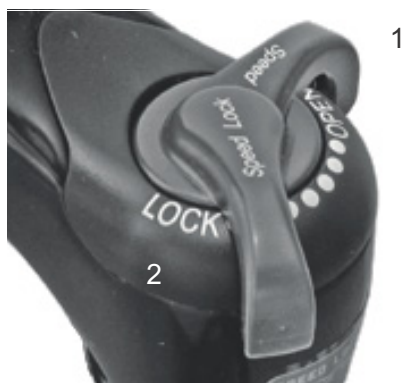
Figura 87: Regulador de niveles de presión Suntour con las posiciones OPEN (1) y LOCK (2)
