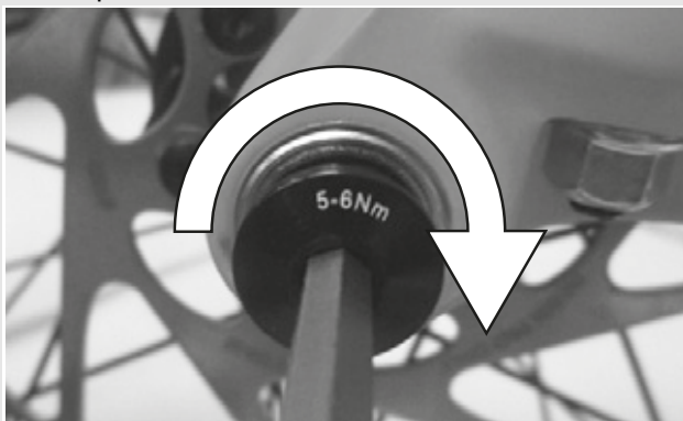
Figura 31: Apriete del tornillo de seguridad
