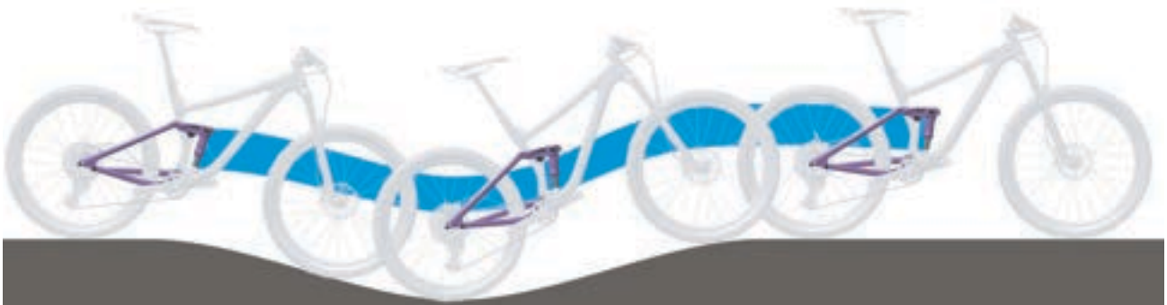
Abbildung 16: Optimales Fahrverhalten des Hinterbau-Dämpfers im hügeligen Gelände
