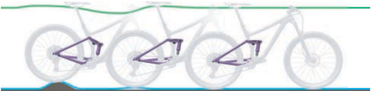
Abbildung 235: Zu schnelles Ausfedern des Hinterbau-Dämpfers
