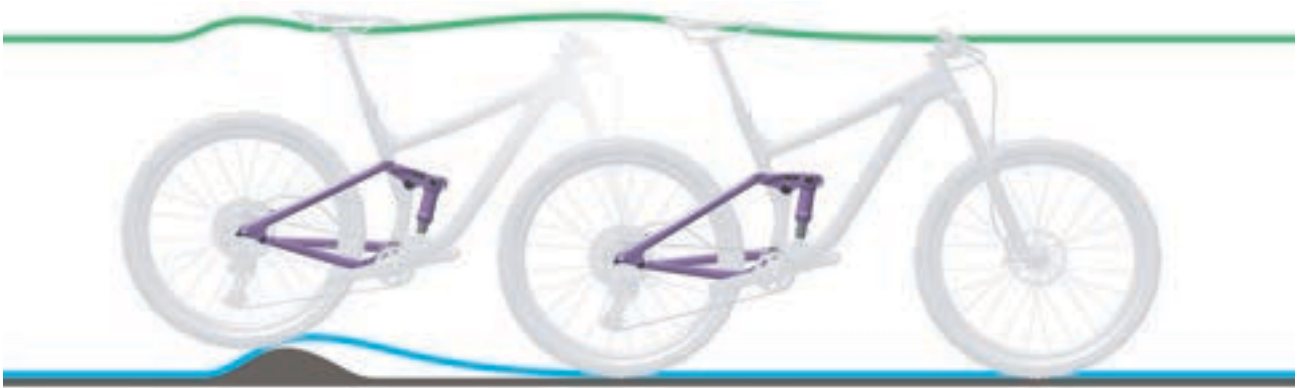
Abbildung 241: Zu harte Dämpfung des Hinterbau-Dämpfers bei Unebenheiten
