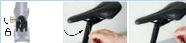
Abbildung 165: Höhenverstellungsbetätigung in „Geöffnete Stellung“ bringen
