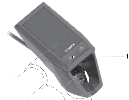
Abbildung 139: Lage Ein-Aus-Taster (Bedieneinheit)
