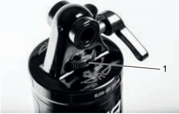
Abbildung 117: Suntour-Zugstufeneinsteller Rad (1) am Hinterbau-Dämpfer
