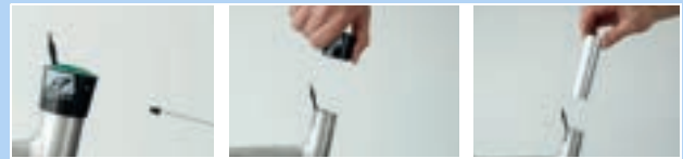
Abbildung 207: Außenhülse und Gleitbuchse ausbauen
