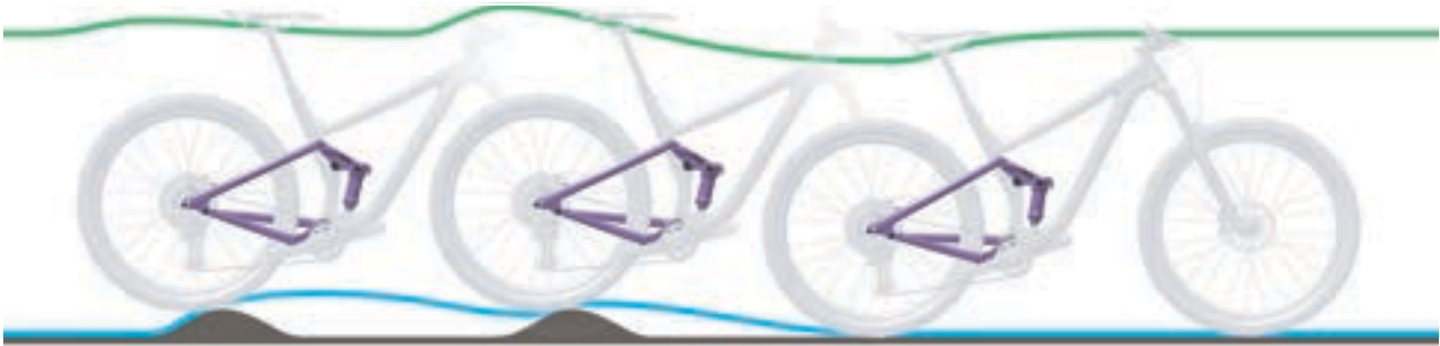
Abbildung 237: Zu langsames Ausfedern des Hinterbau-Dämpfers
