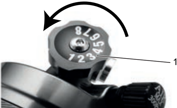
Abbildung 119: Suntour-Druckstufeneinsteller (1) am Hinterbau-Dämpfer
