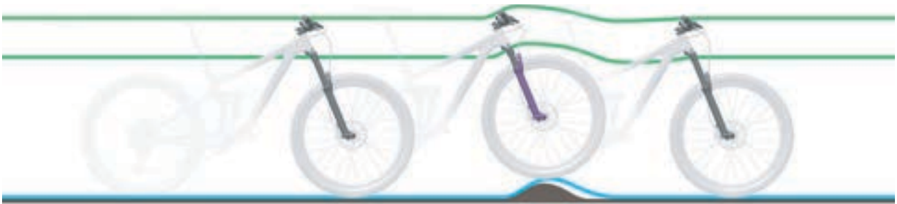
Abbildung 233: Zu harte Dämpfung der Federgabel bei Unebenheiten
