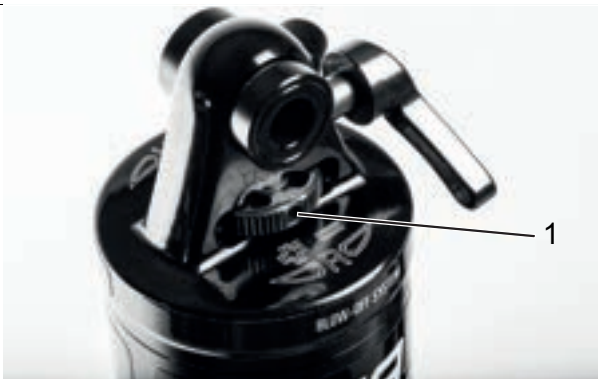
Abbildung 238: Suntour-Zugstufeneinsteller Rad (1) am Hinterbau-Dämpfer
