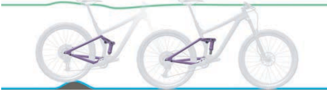
Abbildung 17: Optimales Fahrverhalten des Hinterbau-Dämpfers bei Unebenheiten
