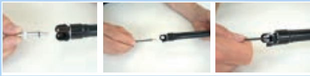
Abbildung 184: Kartusche Ventildeckel befestigen
