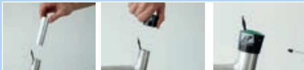
Abbildung 222: Gleitbuchse und Außenhülse einbauen
