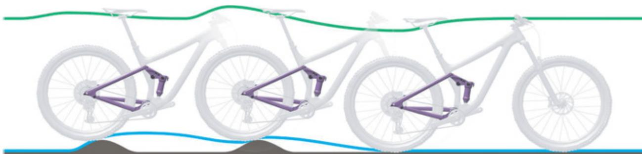
Figura 109: Descompresión demasiado lenta del amortiguador de la horquilla trasera
