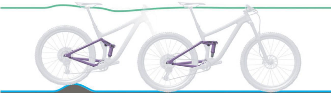
Figura 64: Condición óptima de marcha del amortiguador de la horquilla trasera en caso de irregularidades
