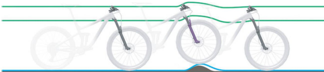
Figura 105: Amortiguación de la horquilla de suspensión demasiado dura en caso de irregularidades
