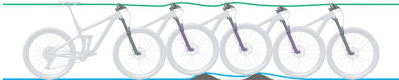
Figura 101: Descompresión demasiado lenta de la horquilla de suspensión
