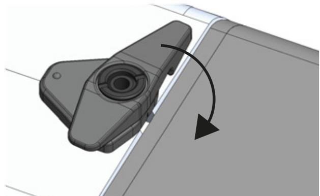
Figura 69: Cierre de la palanca de seguridad
