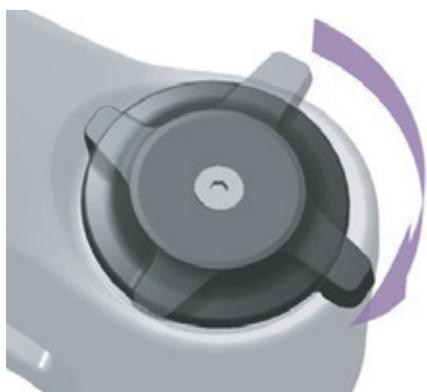
Figura 104: Ajuste para un regulador de niveles de presión más duro
