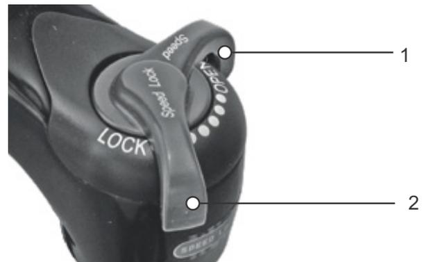
Figura 88: Amortiguador de niveles de presión Suntour en posición abierta (1) y cerrada (2)
