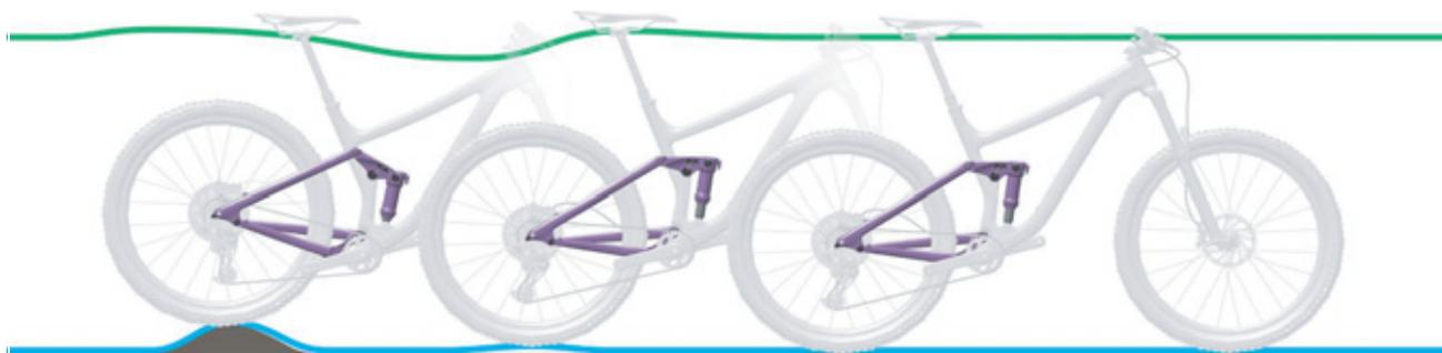
Figura 107: Descompresión demasiado rápida del amortiguador de la horquilla trasera
