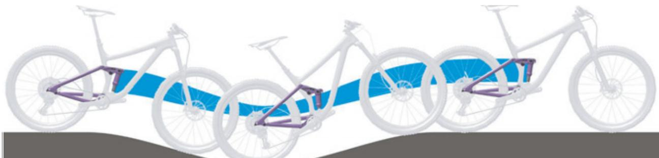
Figura 111: Suspensión del amortiguador de la horquilla trasera demasiado blanda en montaña
