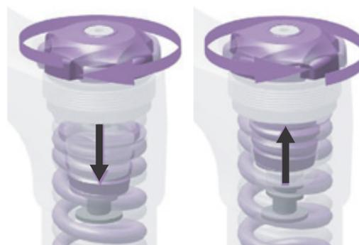
Figura 52: Enroscado y desenroscado del anillo de ajuste de la tensión previa
