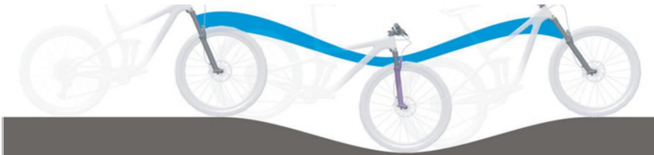
Figura 103: Suspensión de la horquilla de suspensión demasiado blanda en montaña
