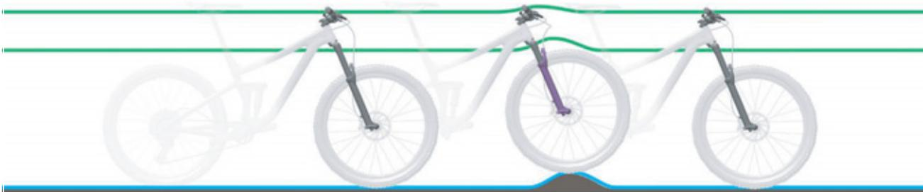
Figura 87: Condición óptima de marcha en terrenos con irregularidades
