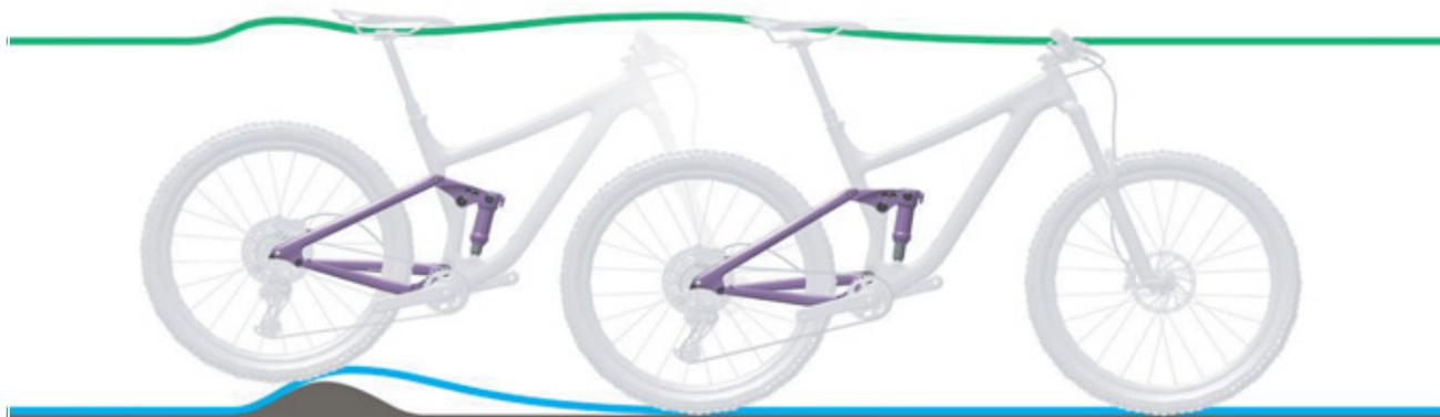
Figura 113: Amortiguación del amortiguador de la horquilla trasera demasiado dura en caso de irregularidades
