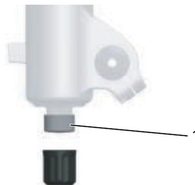
**Abbildung 55:** FOX-Zugstufeneinsteller (1) an der Gabel
