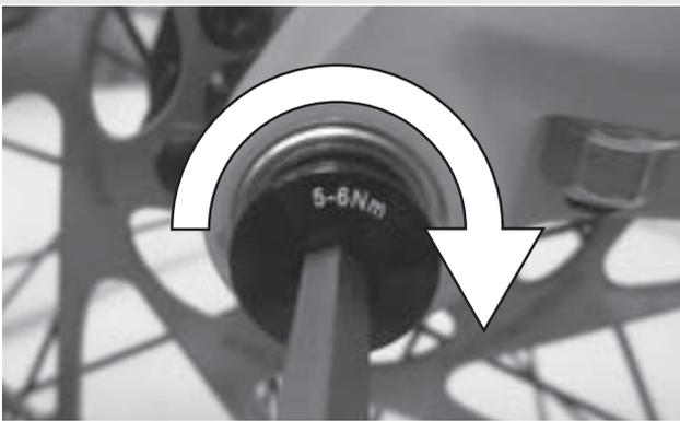
Abbildung 23: Sicherungsschraube anziehen
