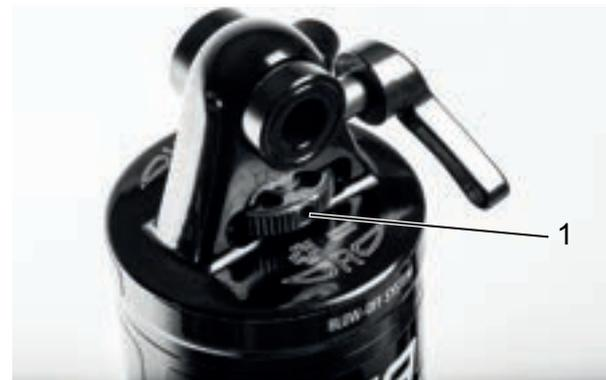
Abbildung 56: Suntour-Zugstufeneinsteller Rad(1) am Hinterbau-Dämpfer
