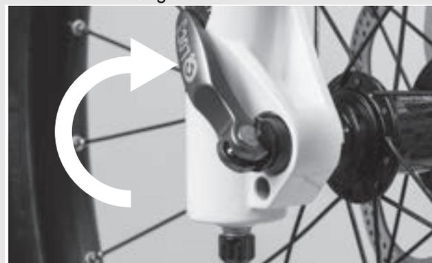
Abbildung 35: Schnellspanner schließen
