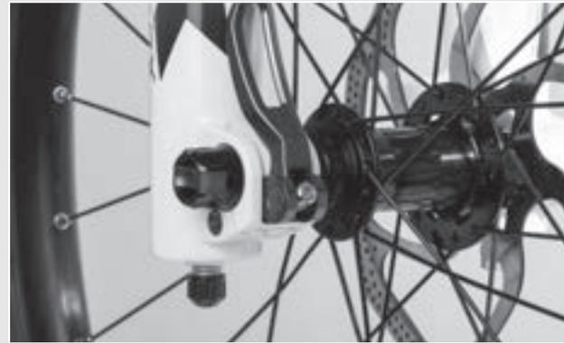
Abbildung 73: Spannkraft des Schnellspanners einstellen
