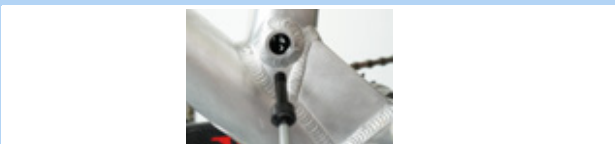
Illustration 168 : Desserrez l'axe Postpin
