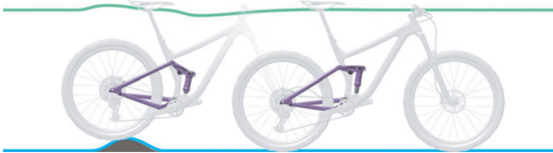
Illustration 17 : Comportement optimal de l'amortisseur arrière sur des irrégularités
