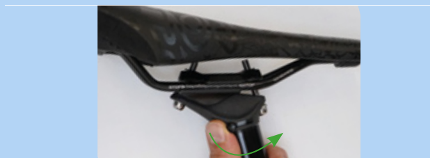
Illustration 216 : Ouvrir le réglage de la hauteur
