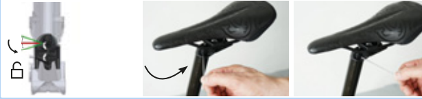
Illustration 165 : Placer le mécanisme de réglage de la hauteur en « position ouverte »
