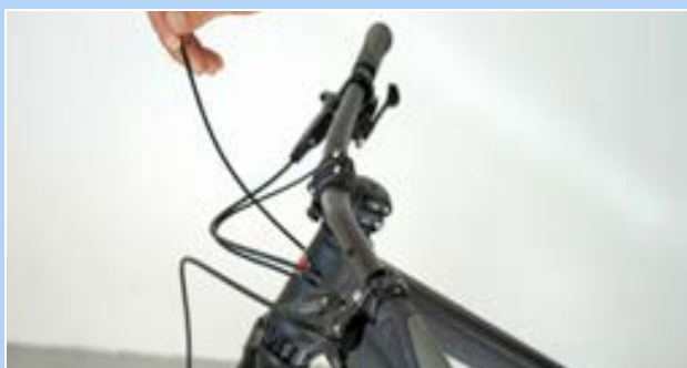
Illustration 224 : Accrocher le capuchon d'extrémité
