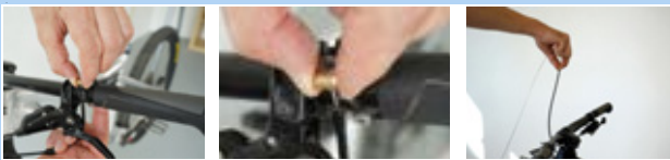
Illustration 204 : Détacher la télécommande
