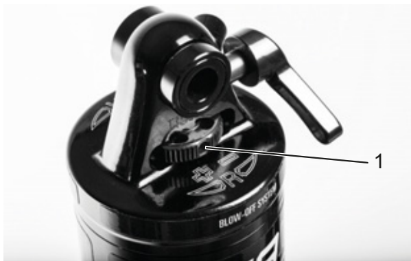
Illustration 236 : Molette de réglage de la détente Suntour (1) sur l'amortisseur arrière
