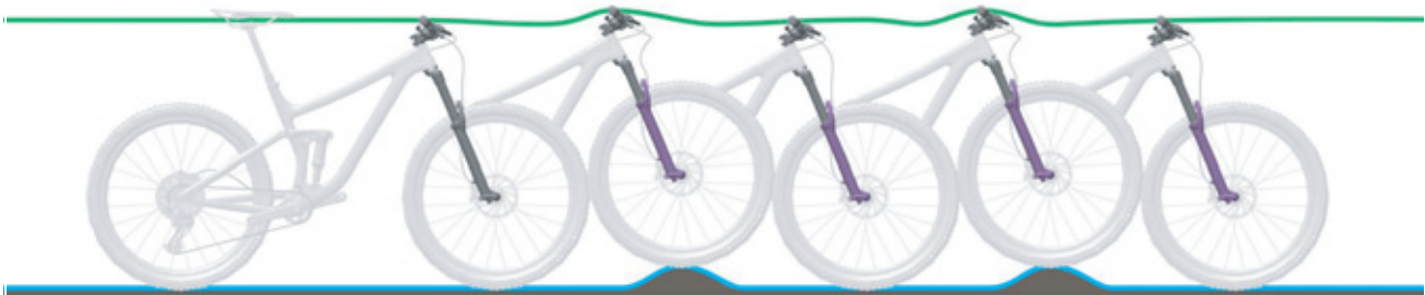
Illustration 11 : Comportement optimal de la fourche
