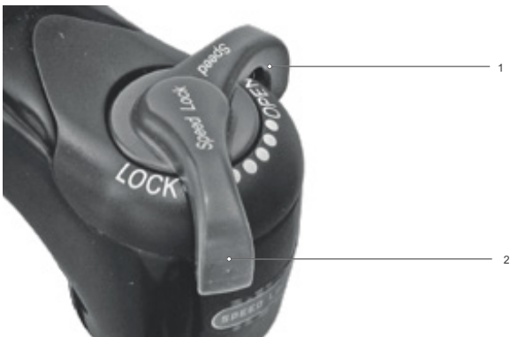
Illustration 232 : Régler le dispositif de réglage de la compression sur un niveau plus dur
