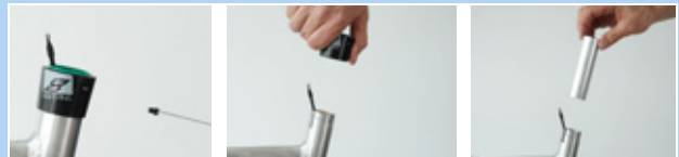
Illustration 207 : Démonter l'enveloppe extérieure et la douille de glissement
