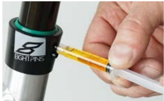
Illustration 150 : Lubrifier un tube de tige de selle
