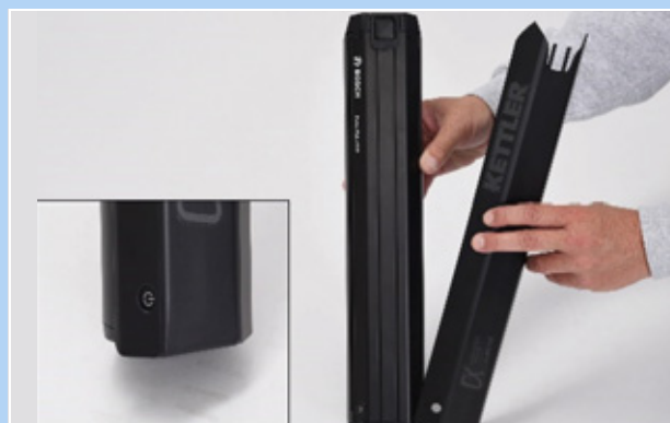
Illustration 60 : Enfoncer le capot de batterie sur la batterie
