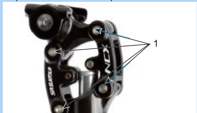
Illustration 164 : Points de lubrification de la tige de selle suspendue SR Suntour
