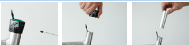
Illustration 173 : Démonter l'enveloppe extérieure et la douille de glissement
