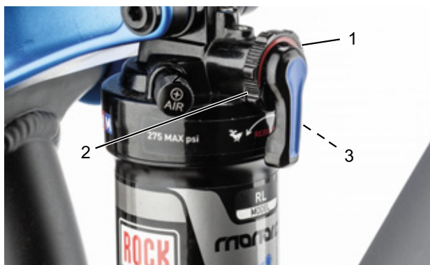
Obr. 82: Nastavení tvrdosti tlumiče odskoku tlumiče zadního odpružení nastavovacím kolečkem (1)
