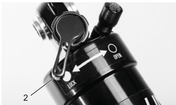
Obr. 81: Nastavovací šroub komprese Suntour zavřený (2)
