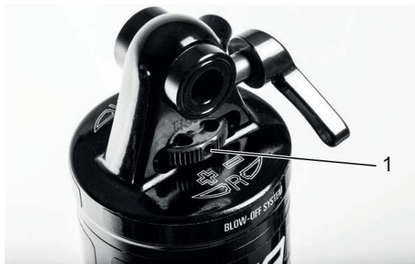
Abbildung 60: Suntour-Zugstufeneinsteller Rad(1) am Hinterbau-Dämpfer
