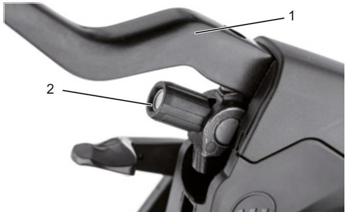
**Figura 77:** Leva del freno (1) del freno a pattino ad azionamento idraulico con vite di regolazione (2)
