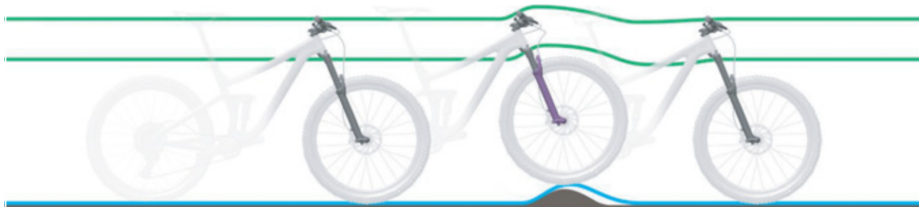
Rysunek 105: Zbyt twarde tłumienie widelca amortyzowanego na nierównościach
