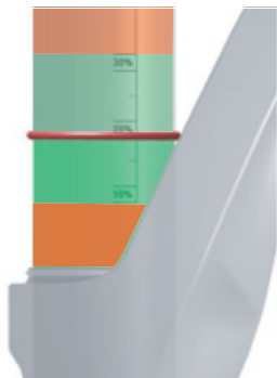
Rysunek 55: Zalecany zakres parametru SAG (zielony) i zakazany zakres parametru AG
