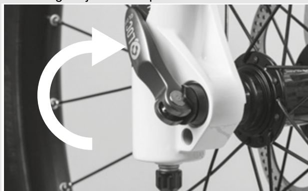
Rysunek 42: Zamykanie zacisku szybko mocującego
