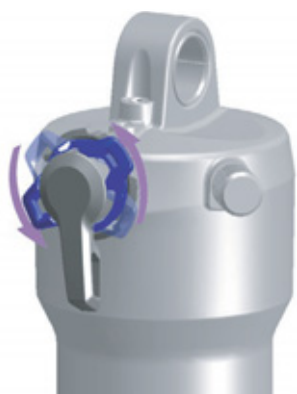
Rysunek 114: Ustawienie nastawnika dobicia na bardziej miękkim trybie pracy
