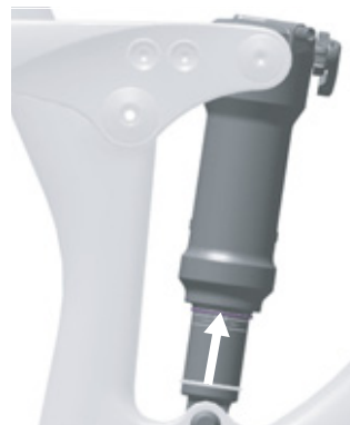
Rysunek 57: Przesuwanie pierścienia o-ring na tylnym amortyzatorze
