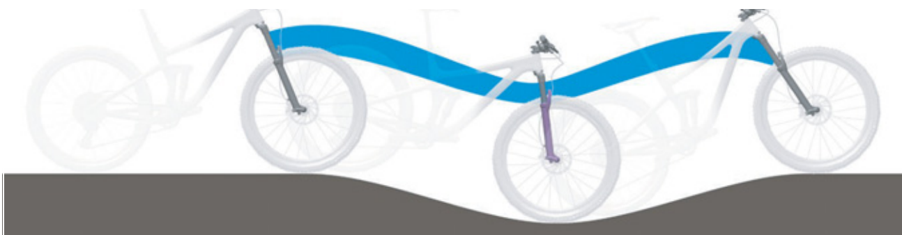
Rysunek 6: Optymalne działanie widełca na pagórkowatym terenie
