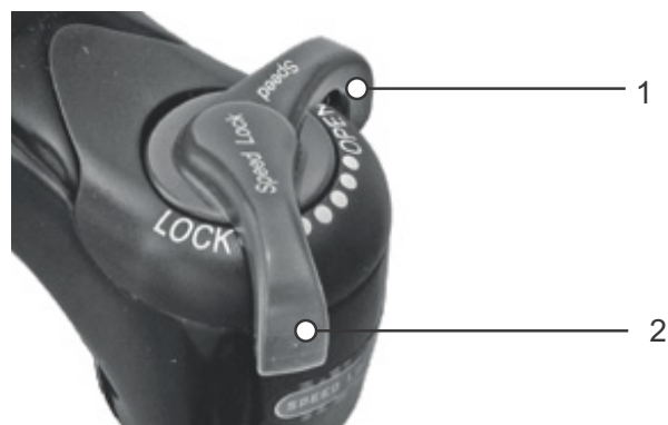
Rysunek 88: Tłumik dobicia Suntour w otwartej (1) i zamkniętej (2) pozycji.
