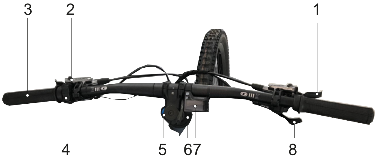
Afbeelding 45: Detailaanzicht stuur met Shimano SC-E800 boordcomputer, voorbeeld
