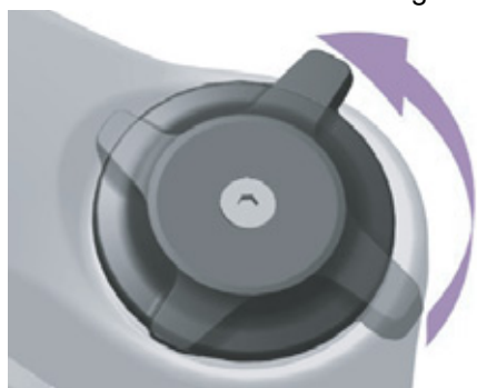
Afbeelding 150: Drukdemperafsteller zachter afstellen
