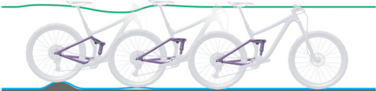
Afbeelding 242: Te snel uitveren van de achterbouwdeemper
