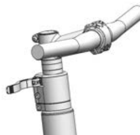
Afbeelding 152: All Up met geopende voorbouwspanhendel
