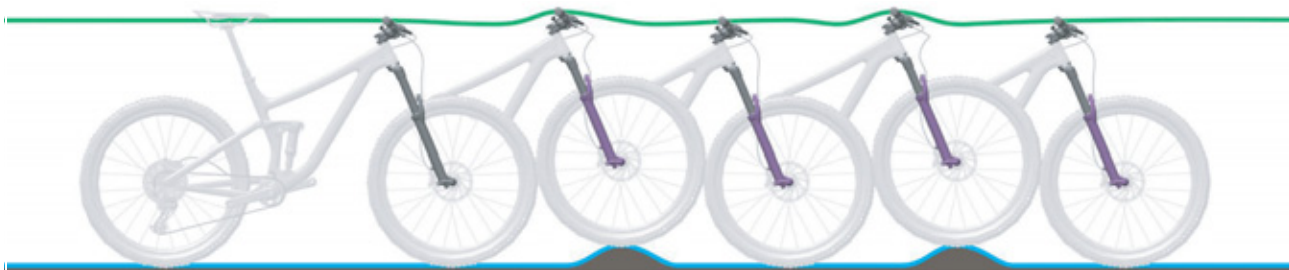
Afbeelding 9: Optimaal rijgedrag van de vork
