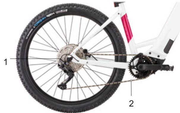
Afbeelding 36: Schema kettingaandrijving met derailleur
