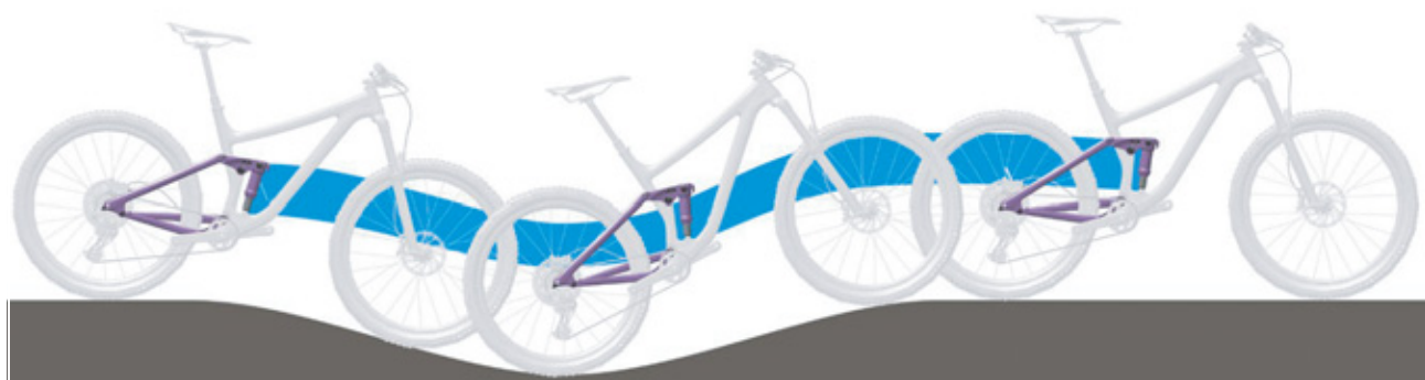
Afbeelding 20: Optimaal rijgedrag van de achterbouwdemper in heuvelachtig terrein
