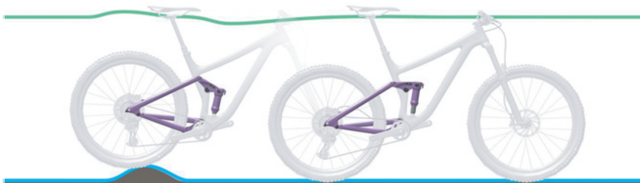
Afbeelding 111: Optimaal rijgedrag van de achterbouwdemper bij oneffenheden
