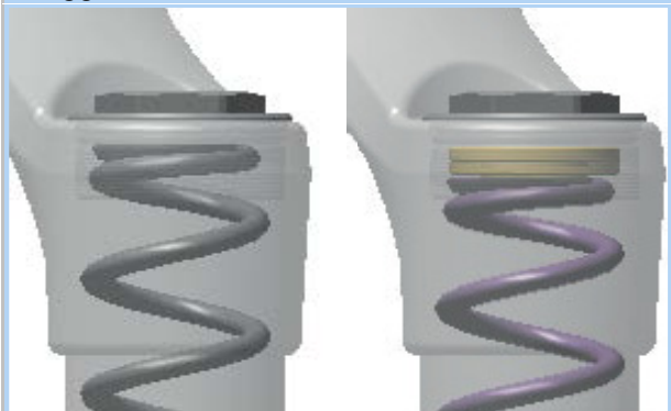
Afbeelding 91: Voorspanningsafstelling in- en uitdraaien
