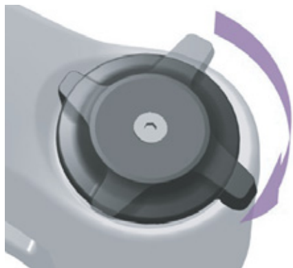
Afbeelding 149: Drukdemperafsteller harder afstellen
