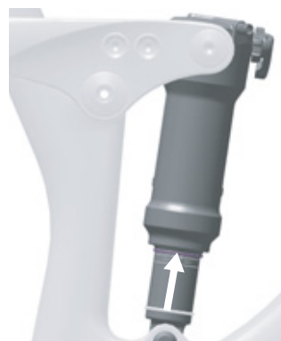
Afbeelding 106: O-ring op de achterbouwdemper verschuiven
