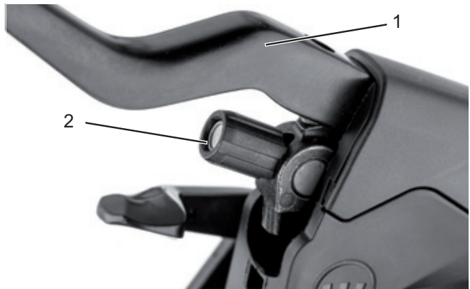
Afbeelding 73: Remhendel (1) van de hydraulisch bediende velgrem met afstelschroef (2)
