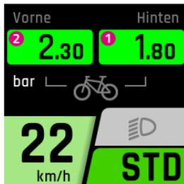
1. Aktueller Reifendruck hinten. (Nur verfügbar mit optionalem Reifendrucksensor)
