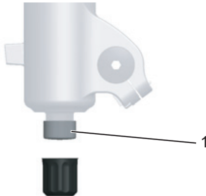
Dispositif de réglage de la détente FOX (1) sur la fourche
