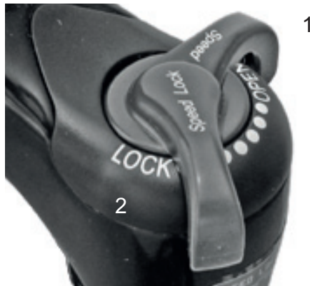
Illustration 65 : Dispositif de réglage de la compression Suntour avec les positions OPEN (1) et LOCK (2)
