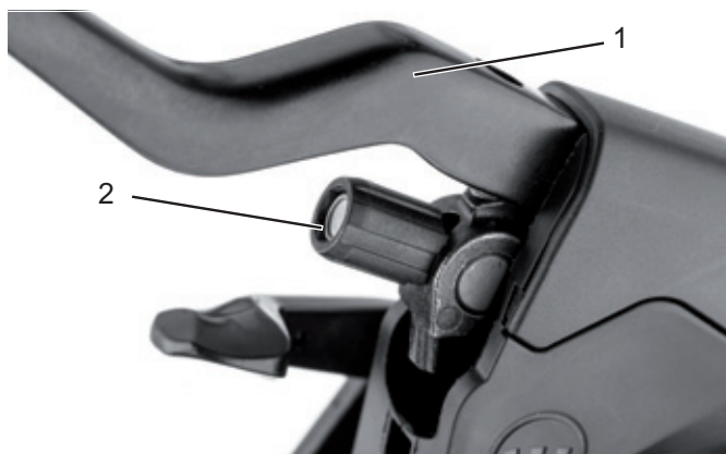
Illustration 78 : Levier de frein (1) du frein de jante à actionnement hydraulique avec vis de réglage (2)
