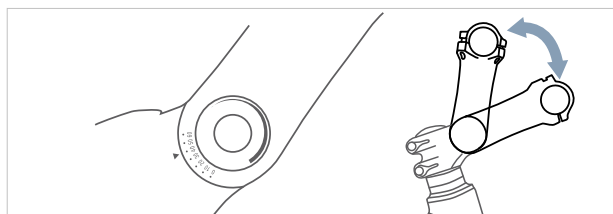
Slika 28: Različne izvedbe po kotu nastavljlivih sprednjih delov S prilagajanjem kota sprednjega dela (c) se spremenita razdalja med zgornjim delom telesa in krmilom (b) ter tudi višina krmila (a).
