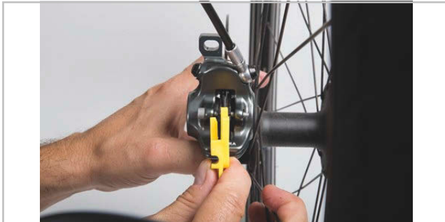
Slika 51: Preverjanje zavorne obloge v vgrajenem stanju s pomočjo transportnega varovala
