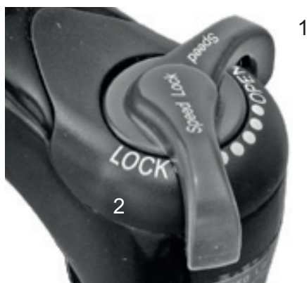
Figura 59: Regolatore della compressione Suntour con posizioni OPEN (1) e LOCK (2)
