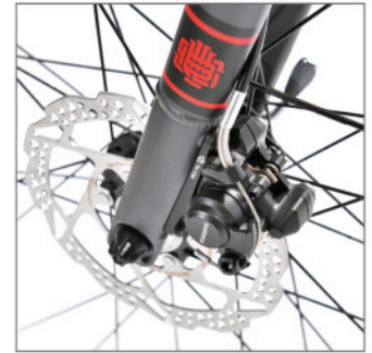
Einwandfrei und gut zu warten: die mechanische Scheibenbremse
