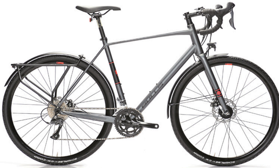
Einwandfrei und gut zu warten: die mechanische Scheibenbremse
