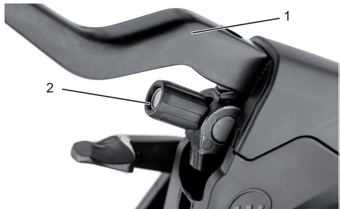
Abbildung 74: Bremshebel (1) der hydraulisch betätigten Felgenbremse mit Einstellschraube (2)
