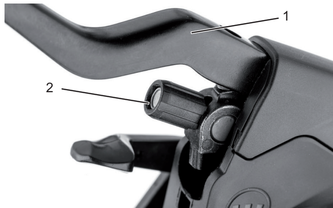
Afbeelding 84: Remhendel (1) van de hydraulisch bediende velgrem met afstelschroef (2)
