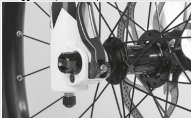
Figura 79: Regolazione della forza di serraggio del bloccaggio rapido
