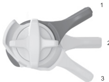
Illustration 73 : Dispositif de réglage de la compression FOX sur l'amortisseur arrière avec les positions OUVERT (1), MOYEN (2) et DUR (3)
