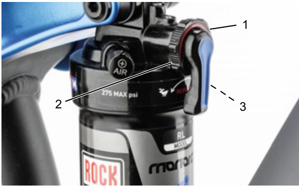
Figura 77: Ajuste de la dureza del amortiguador de niveles de tracción en la rueda de ajuste (1) del amortiguador de la horquilla trasera
