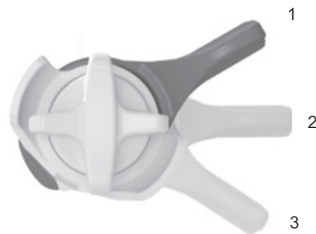
Figura 72: Regulador de niveles de presión FOX en el amortiguador de la horquilla trasera con las posiciones ABIERTO (1), MEDIO (2) y DURO (3)
