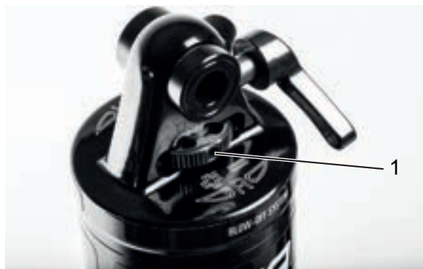
Abbildung 60: Suntour-Zugstufeneinsteller Rad(1) am Hinterbau-Dämpfer
