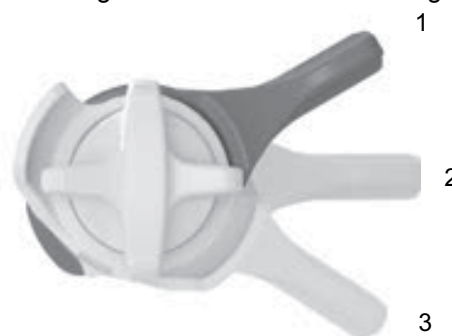
Abbildung 73: FOX-Druckstufeneinsteller am Hinterbau-Dämpfer mit den Positionen OFFEN (1), MITTEL (2) und HART (3)
