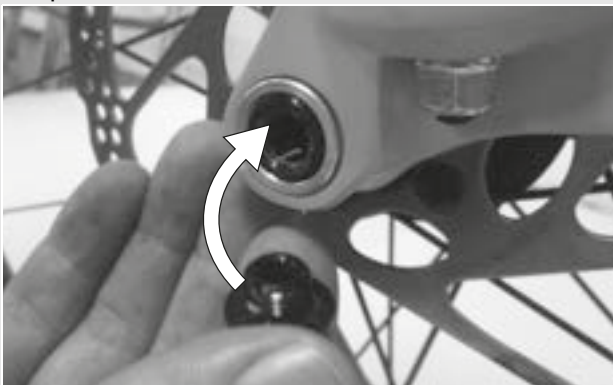
Figura 25: Applicazione della leva del bloccaggio rapido nel perno
