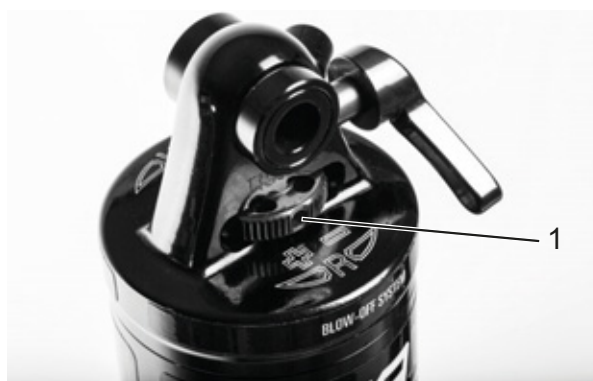
Figura 59: Regolatore del rebound Suntour (1) sull'ammortizzatore del carro posteriore
