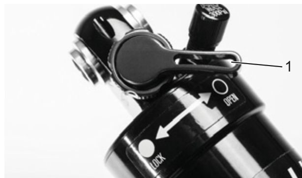
Figura 75: Regolatore della compressione Suntour aperto (1)
