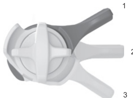
Figura 72: Regolatore della compressione FOX sull'ammortizzatore del carro posteriore con le posizioni APERTO (1), MEDIO (2) e RIGIDO (3)
