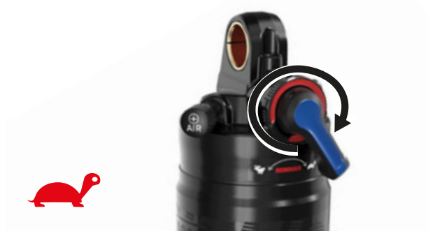
Obr. 61: Snížení rychlosti roztahování
