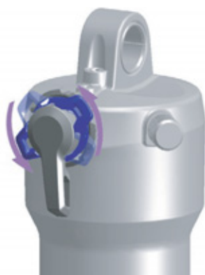
Obr. 114: Měkké nastavení nastavovacího šroubu komprese
