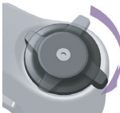
Obr. 89: Tvrdé nastavení nastavovacího šroubu komprese
