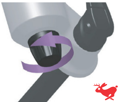
Obr. 102: Otáčení tlumiče zpětného odskoku směrem k zajíci
