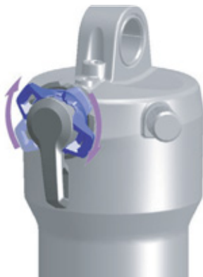
Obr. 112: Tvrdé nastavení nastavovacího šroubu komprese
