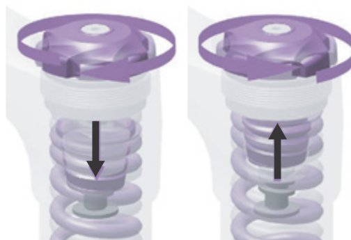
Obr. 52: Otáčení nastavovacím kroužkem předpětí dovnitř a ven
