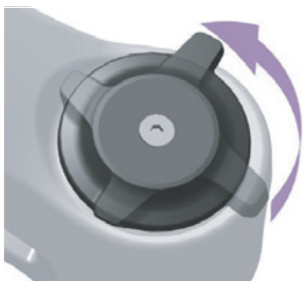
Obr. 106: Měkké nastavení nastavovacího šroubu komprese
