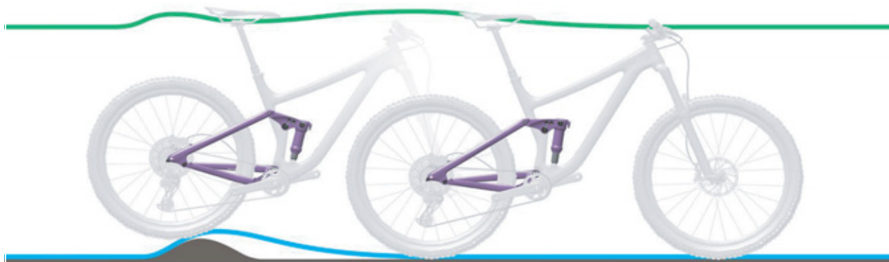
Obr. 113: Příliš tvrdé tlumení tlumiče zadního odpružení u nerovností
