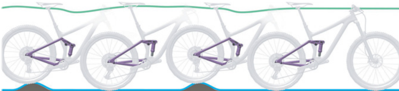
Obr. 10: Optimální chování tlumiče zadního odpružení při jízdě
