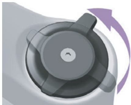
Obr. 90: Měkké nastavení nastavovacího šroubu komprese
