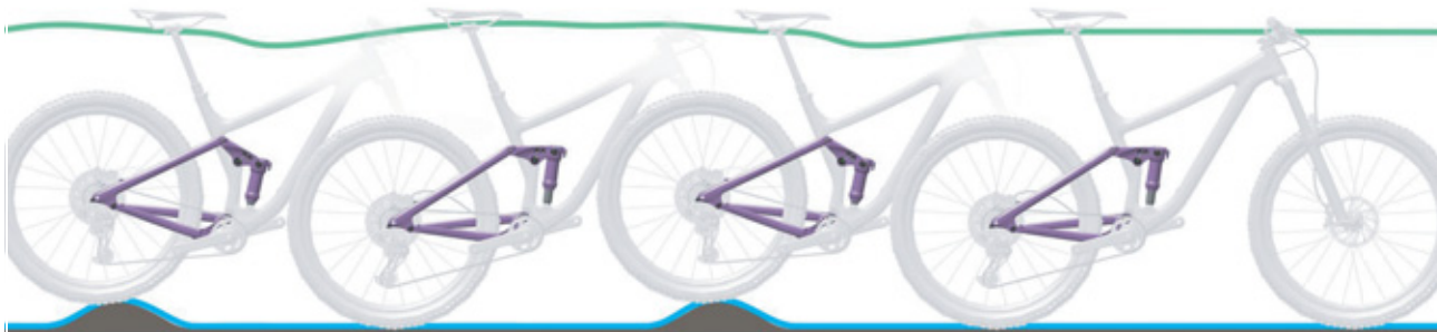
Obr. 59: Optimální chování tlumiče zadního odpružení při jízdě
