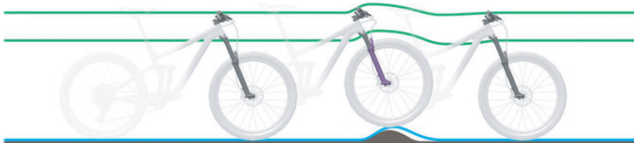
Obr. 105: Příliš tvrdé tlumení odpružené vidlice u nerovnosti
