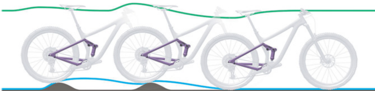
Obr. 109: Příliš pomalé roztahování tlumiče zadního odpružení
