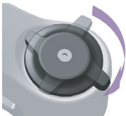
Obr. 104: Tvrdé nastavení nastavovacího šroubu komprese
