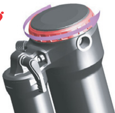
Obr. 110: Otáčení tlumiče zpětného odskoku směrem k zajíci
