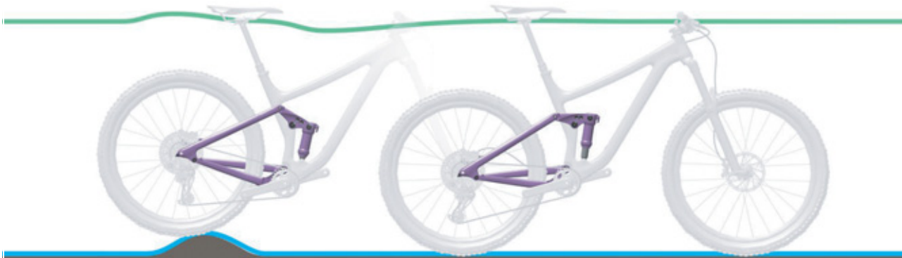
Obr. 64: Optimální chování tlumiče zadního odpružení při jízdě u nerovností
