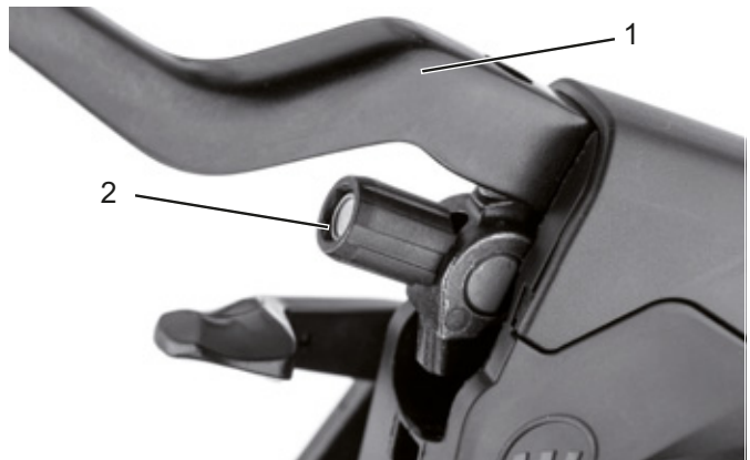
Rysunek 81: Dźwignia (1) hydraulicznego hamulca obręczowego ze śrubą nastawczą (2)
