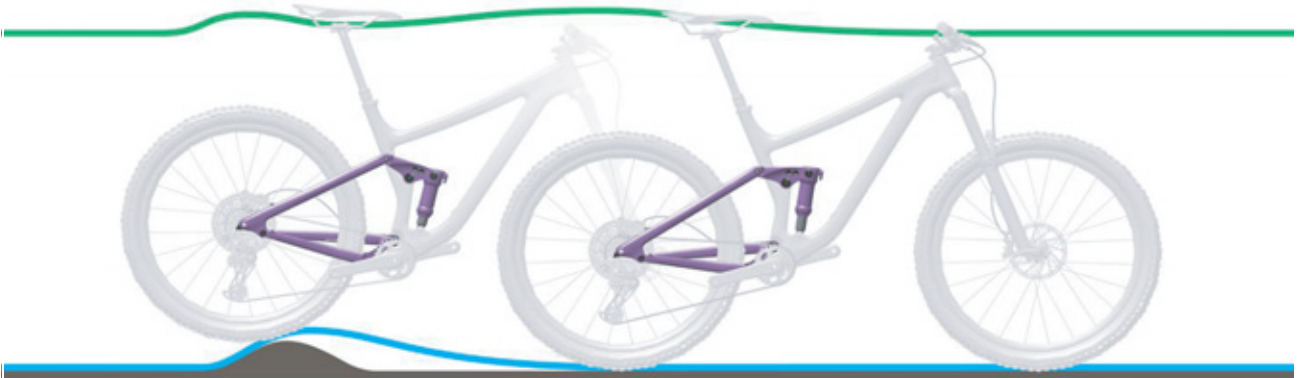
248. ábra: A hátsó lengéscsillapító túl kemény csillapítása egyenetlenségeknél
