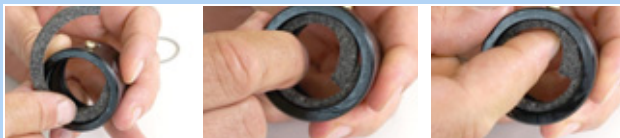
185. ábra: Filcgyűrű behelyezése
