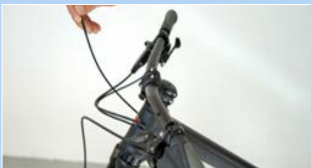
231. ábra: Végsapka beakasztása
