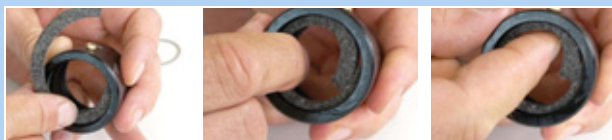
220. ábra: Filcgyűrű behelyezése
