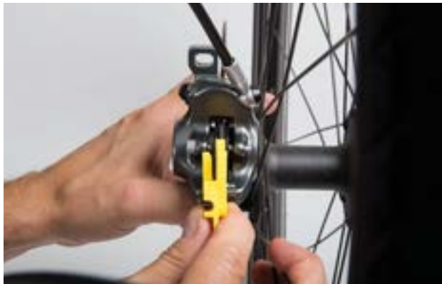
161. ábra: Fékbetét ellenőrzése beépített állapotban a szállítási rögzítés segítségével
