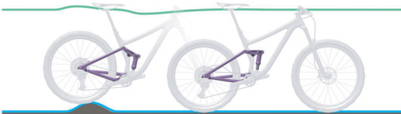
111. ábra: A hátsó lengéscsillapító optimális menetviselkedése egyenetlenségeknél
