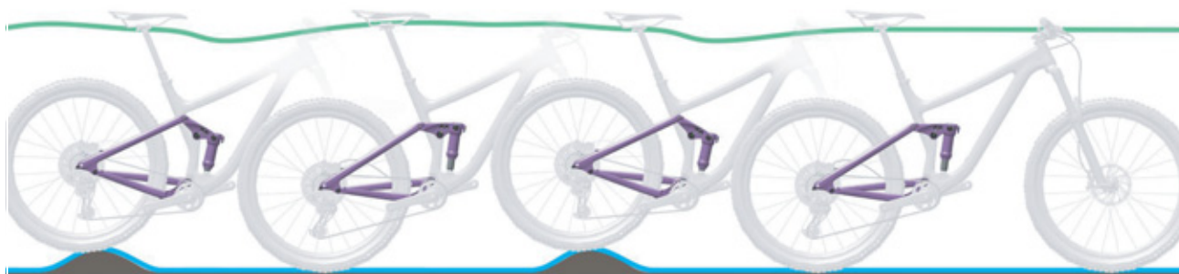
16. ábra: A hátsó lengéscsillapító optimális menetviselkedése
