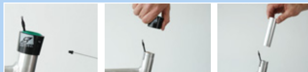
214. ábra: Külső hüvely és siklópersely kiszérése
