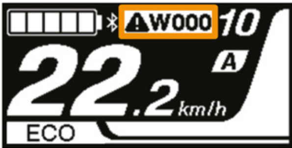
61. ábra: Példa: W000 figyelmeztetés
