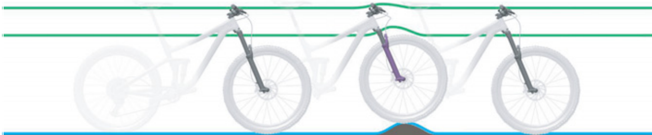
11. ábra: A villa optimális menetviselkedése egyenetlenségek esetén
