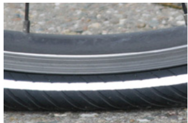
82. ábra: Túlontúl alacsony töltőnyomás
