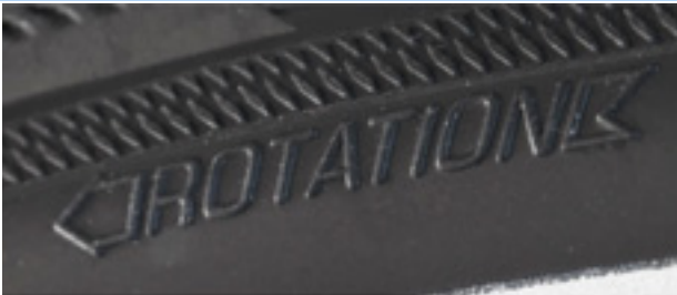
56. ábra: Futásirányjelző nyíl
