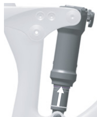
106. ábra: O-gyűrű eltolása a hátsó lengéscsillapítón
