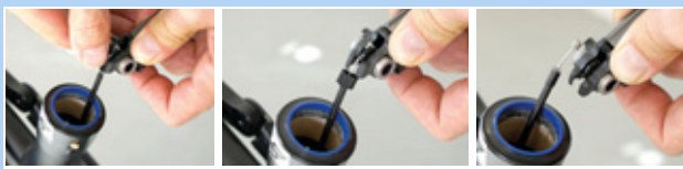
213. ábra: Bovden eltávolítása
