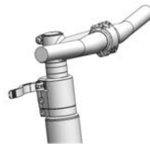
152. ábra: All Up nyitott kormányház gyorskioldóval
