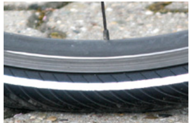
81. ábra: Helyes töltőnyomás. A gumiabroncs alakja a testsúly terhe alatt alig változik
